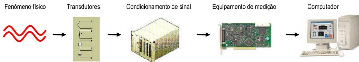
**Figura 1 - Diagrama funcional de um sistema de aquisição genérico**
