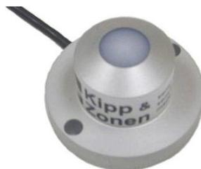
Figura 32 - Piranômetro a ser utilizado no projeto
