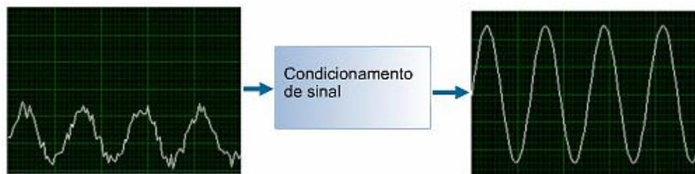
**Figura 3 - Exemplo de condicionamento: filtragem e amplificação**
