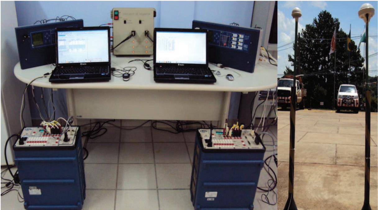
**Figura 23 – Bancada de ensaio em laboratório e antenas de GPS no pátio.
