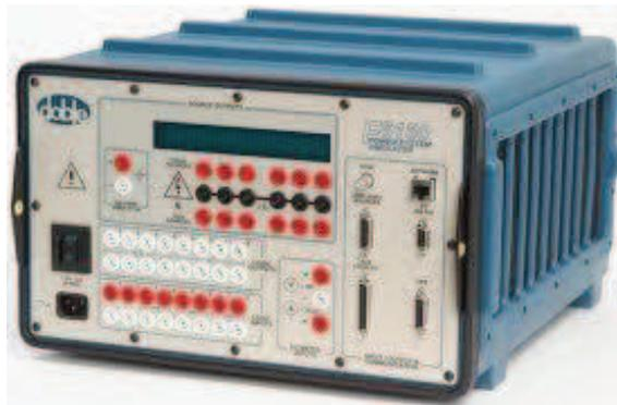
**Figura 20 – Fonte de ensaio F6150.
