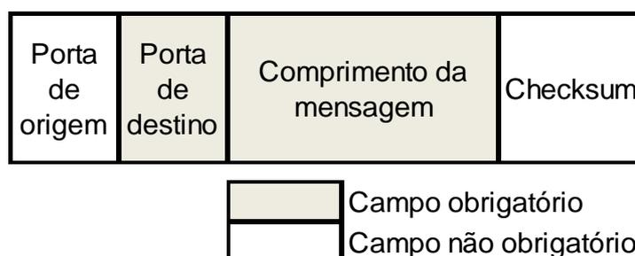
**Figura 10 – Cabeçalho do protocolo UDP**
