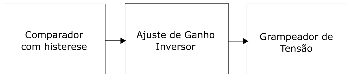
Figura 23. Circuito amostrador de tensão. Fonte: Autoria própria (2018).
