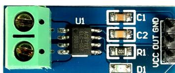
**Figura 30 – Placa do ACS712 periférico arduíno.**
