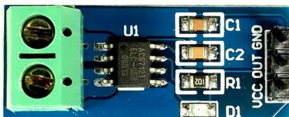
Figura 68 – Placa do ACS712 para uso em Arduino.
