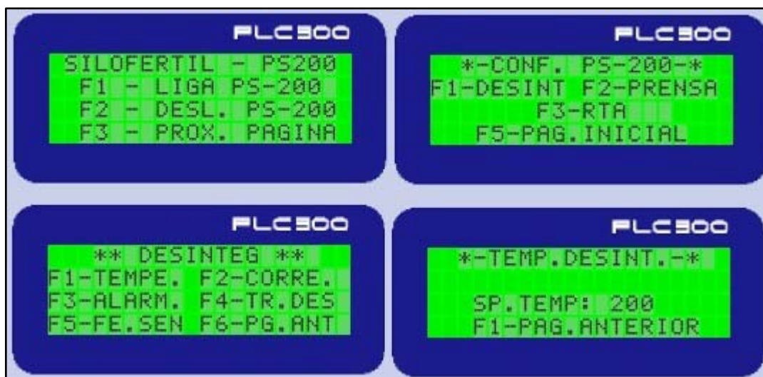
Figura 15: Programação das telas de IHM do PLC-300
