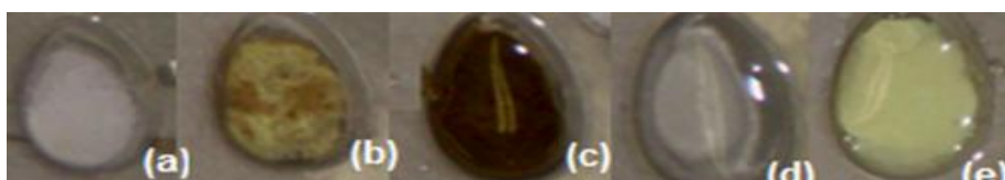
Figura 8 - Reações do \text{AgNO}_3 com: a) \text{NaCl} , (b) \text{Na}_2\text{CO}_3 , (c) \text{NaOH} , (d) \text{K}_2\text{SO}_4 , (e) \text{KI} . Fonte: Própria.
