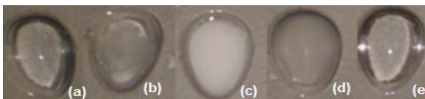
Figura 9 - Reações do \text{CaCl}_2 com: a) \text{NaCl} , b) \text{Na}_2\text{CO}_3 , c) \text{NaOH} , d) \text{K}_2\text{SO}_4 , e) \text{KI} . Fonte: Própria.
