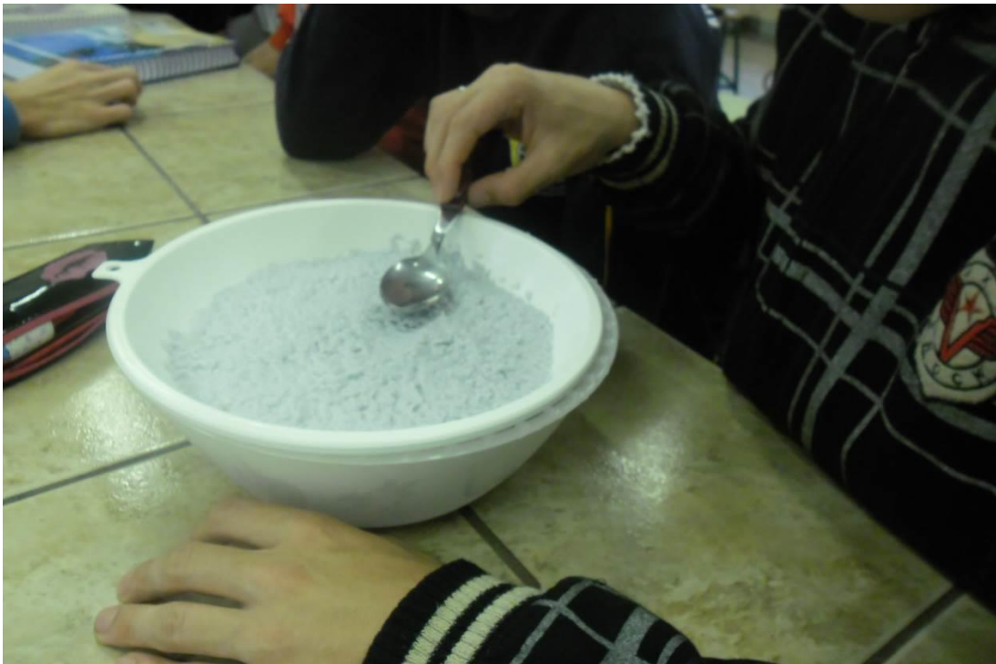
Figura 5 – Retirada do excesso de água da massa. Fonte: Autoria própria.
