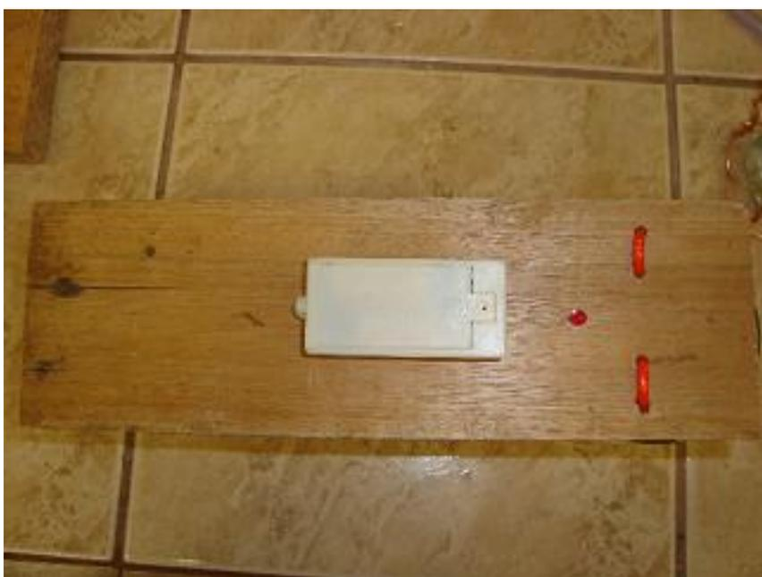
**Figura 5 – Parte superior do aparelho para teste de condutividade el trica.**
