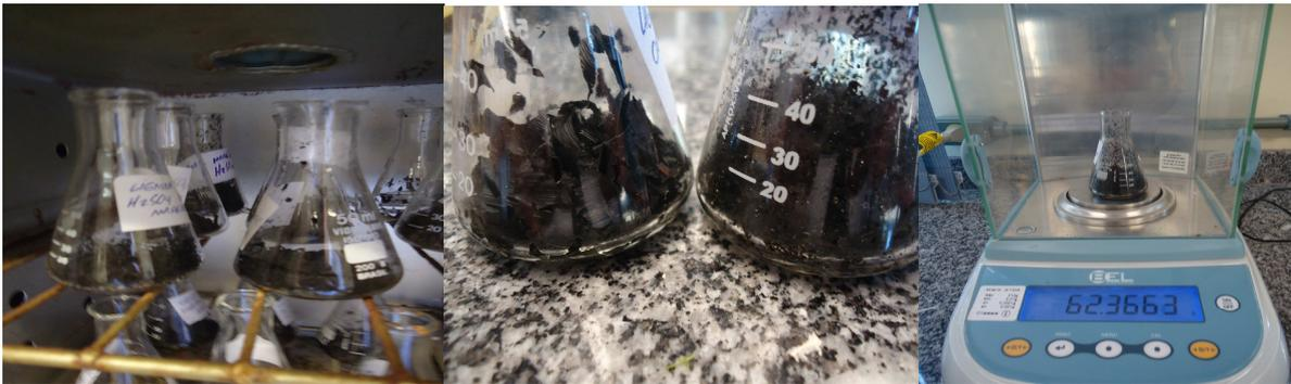
**Figura 23 – Amostras de ligninas pelo método Willstatter durante procedimentos de secagem e pesagem.**
