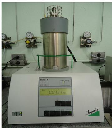
**Figura 20 – Equipamento utilizado na determinação do PCS da biomassa**
