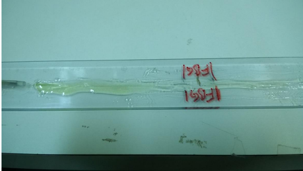
Figura 26 - FBG utilizada para simular um evento de mastigação.
