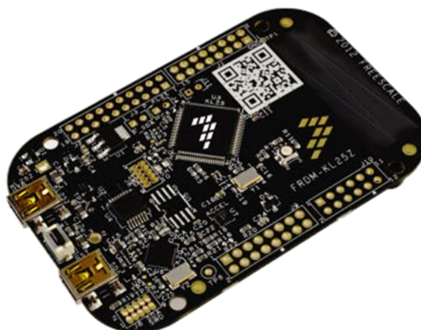
Figura 6. Placa de desenvolvimento NXP FRDM-KL25Z com MCU ARM Cortex M0+.
