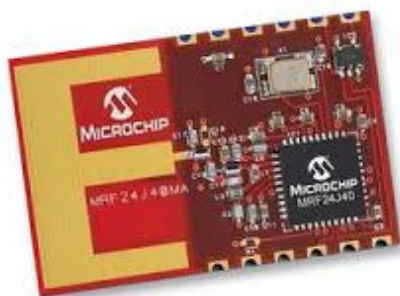
Figura 10 - Módulo de rádio MRF24J40MA. Fonte: Farnell (2014).
