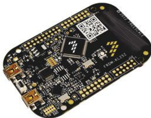
Figura 9 - Ferramenta de desenvolvimento FRDM-KL25Z. Fonte: Mouser Eletronics (2014).
