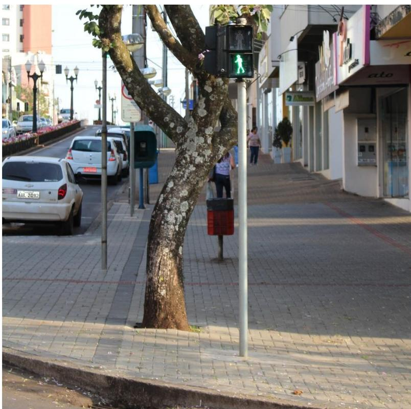
**Figura 15: Semáforo repetidor para pedestres**
