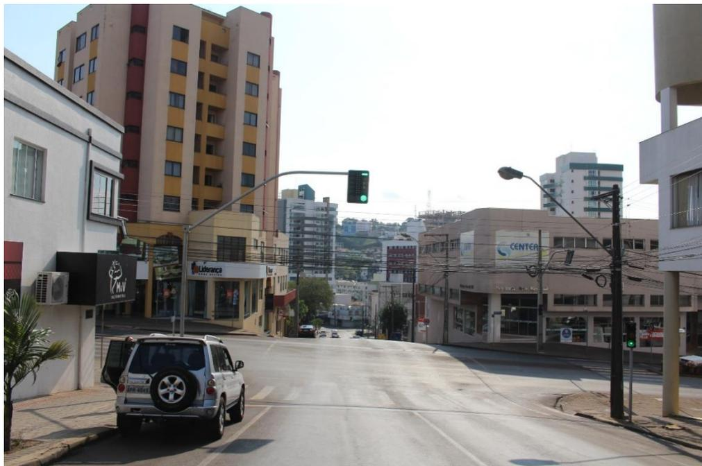
**Figura 12: Foco semafórico antes da via transversal**
