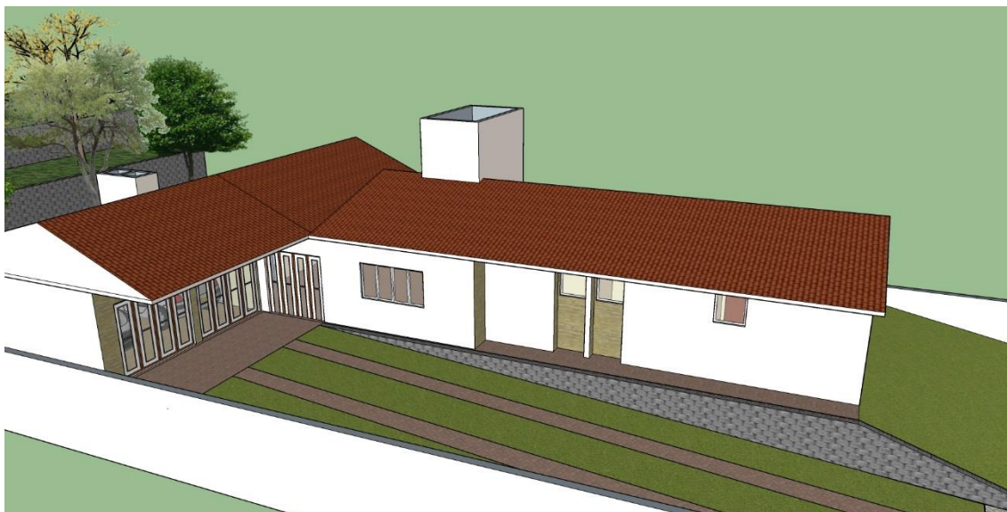
FIGURA 35 - COBERTURA EM TELHA CERÂMICA.
