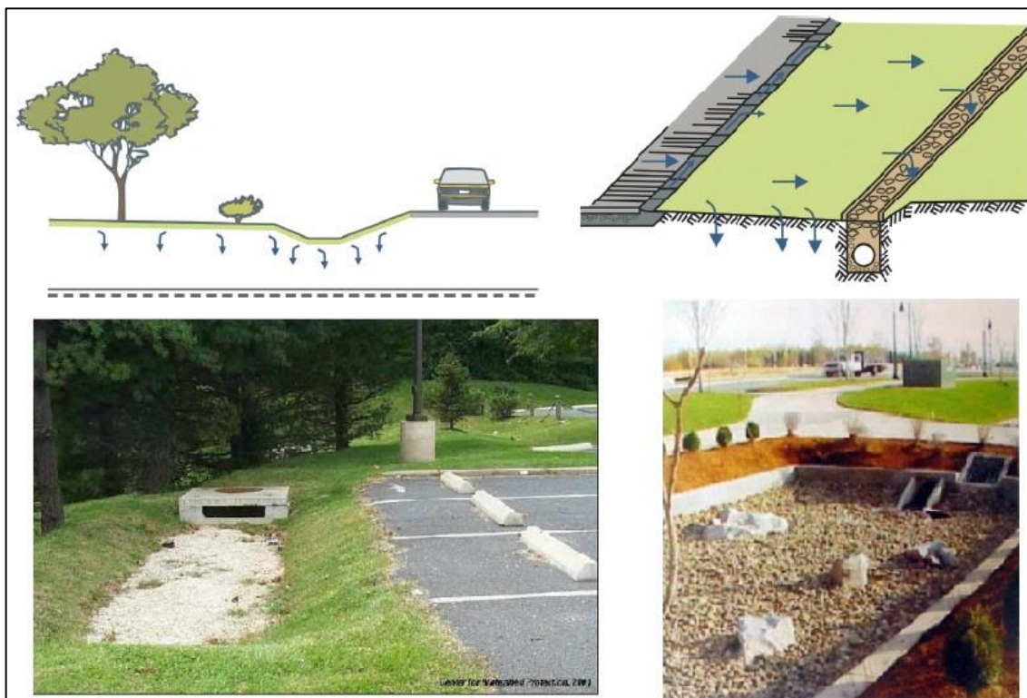
Figura 4 – Exemplos de dispositivos de infiltração: valas de infiltração (acima), trincheira de infiltração (esquerda) e bacia de percolação (direita).
