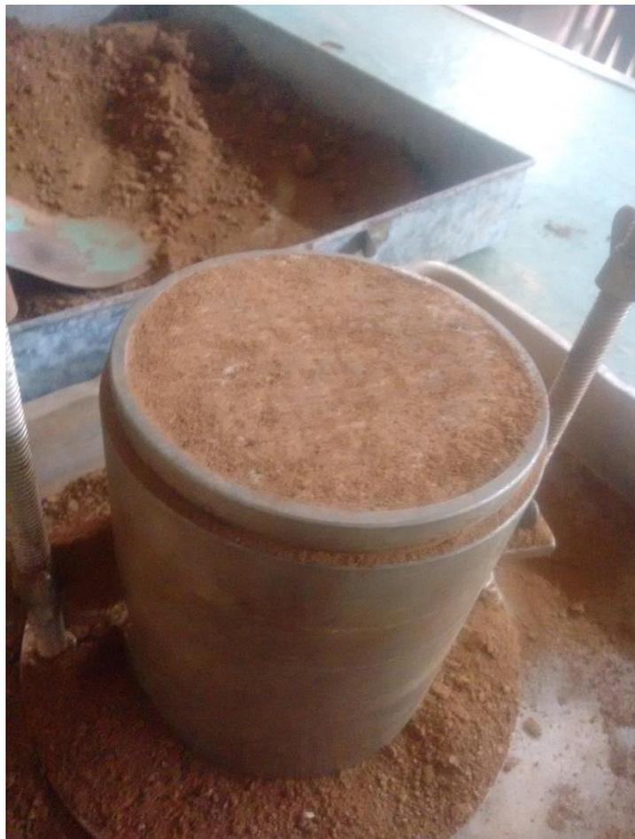
**Figura 12 - Solo compactado no molde com superfície regularizada**
