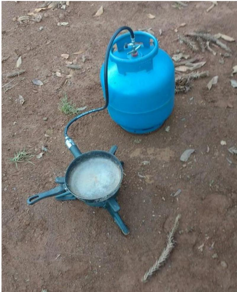
**Figura 13 - Equipamento para execução do Método da Frigideira**
