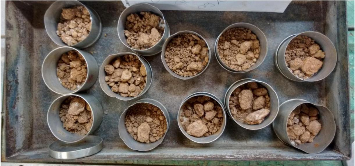
**Figura 11 - Solo nas Cápsulas para Secagem em estufa**
