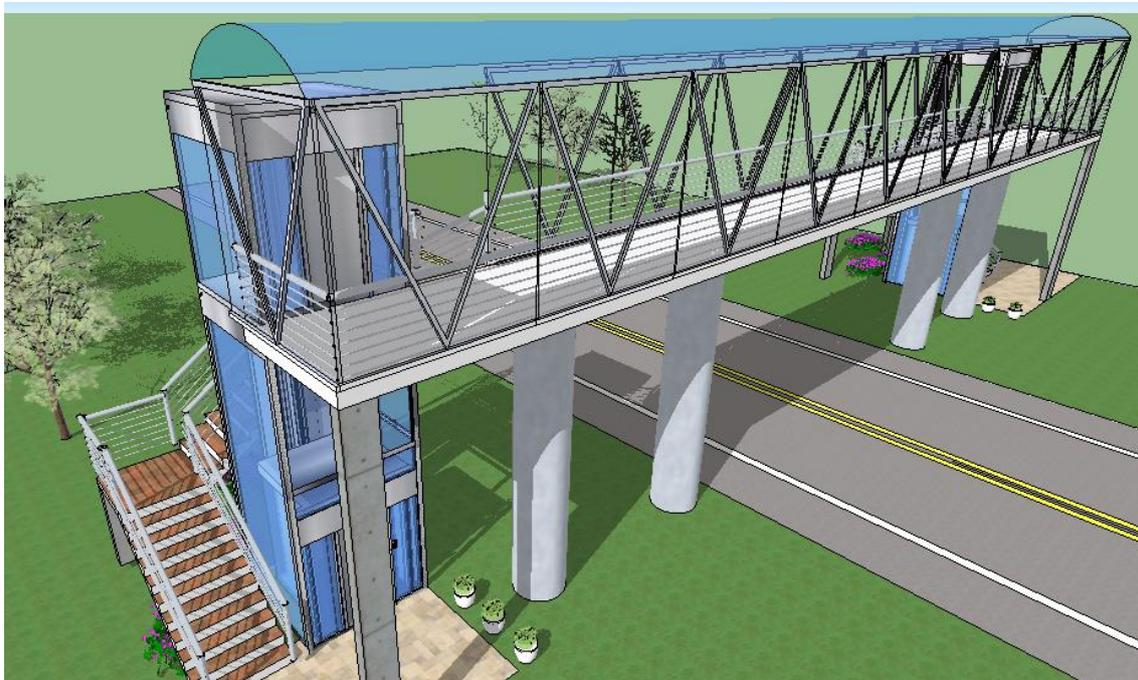
**Figura 67 - Demonstrativo 3D do projeto arquitetônico final da passarela de pedestres sobre rodovia – detalhe da cobertura**
