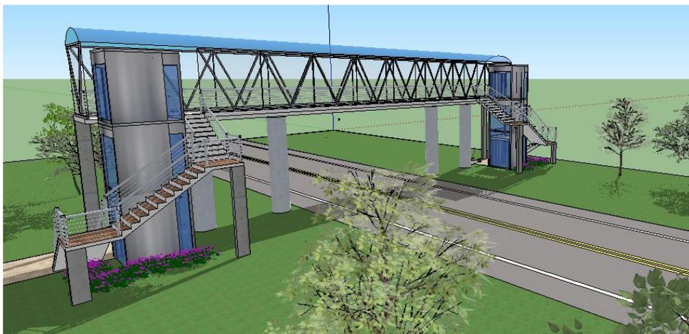
**Figura 65 - Demonstrativo 3D do projeto arquitetônico final da passarela de pedestres sobre rodovia – detalhe da escada**
