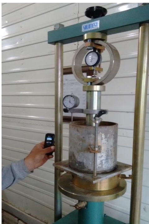
Figura 23 - Corpo de prova pronto para ensaio de penetração Fonte: Aatoria própria.
