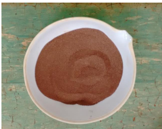
Figura 14 - Amostra preparada para o ensaio de limite de liquidez Fonte: Autoria própria.
