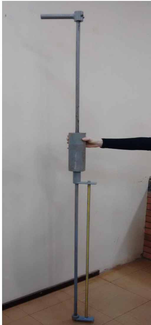
Figura 5 - Cone de penetração dinâmica utilizado na pesquisa Fonte: Autoria própria.
