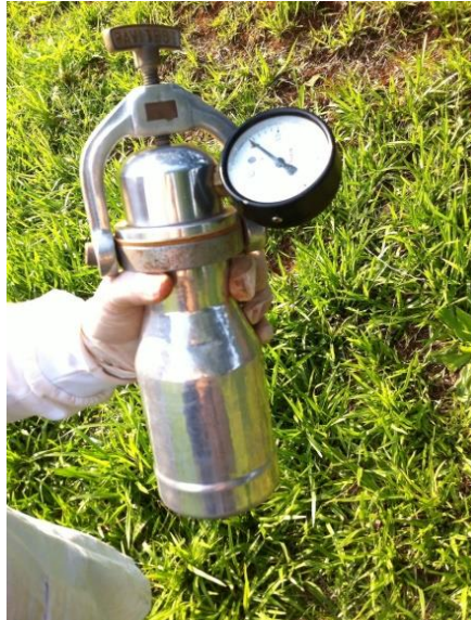
Figura 26 - Agitação da garrafa do aparelho de umidade pressão Fonte: Autoria própria.
