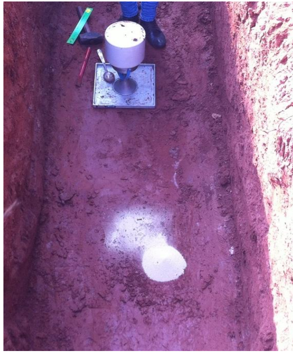
Figura 30- Conjunto posicionado no furo e areia residual do ensaio Fonte: Autoria própria.
