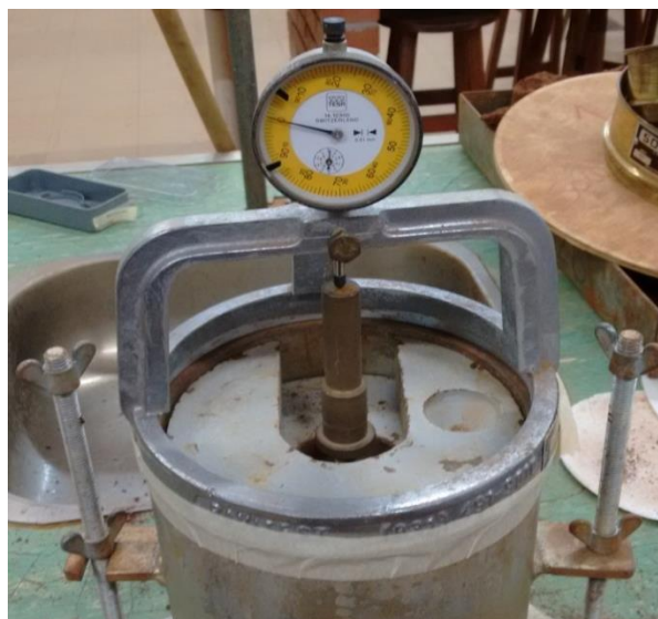
Figura 22 - Corpo de prova pronto para ensaio de expansão Fonte: Autoria própria.
