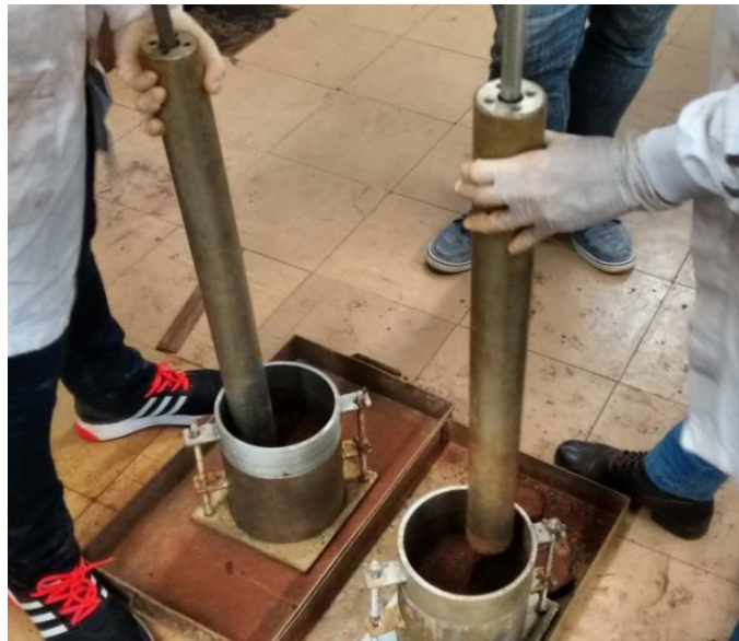
Figura 20 - Compactação de uma camada do corpo de prova Fonte: Autoria própria.
