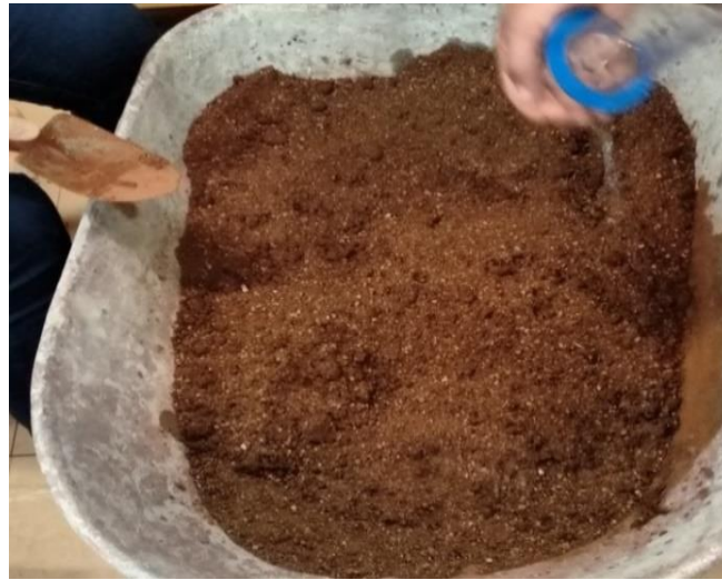
Figura 19 - Homogeneização da amostra Fonte: Autoria própria.
