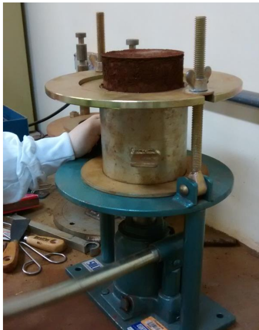
Figura 17 - Corpo de prova sendo extraído no extrator Fonte: Autoria própria.
