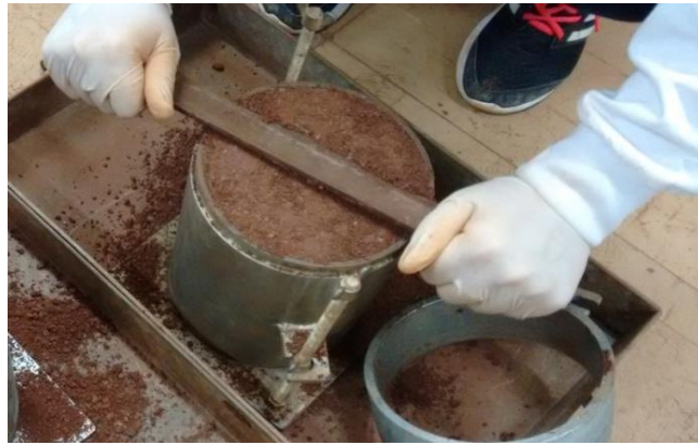
Figura 21 - Remoção do excesso de solo com a régua biselada Fonte: Autoria própria.
