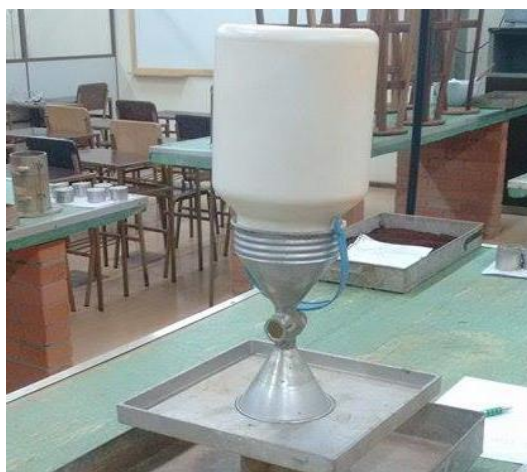
Figura 27 - Determinação da massa específica aparente da areia Fonte: Autoria própria.
