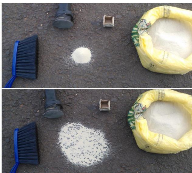
Figura 19 - Etapas envolvidas no ensaio de Mancha de Areia FONTE: Autoria Própria (2015)
