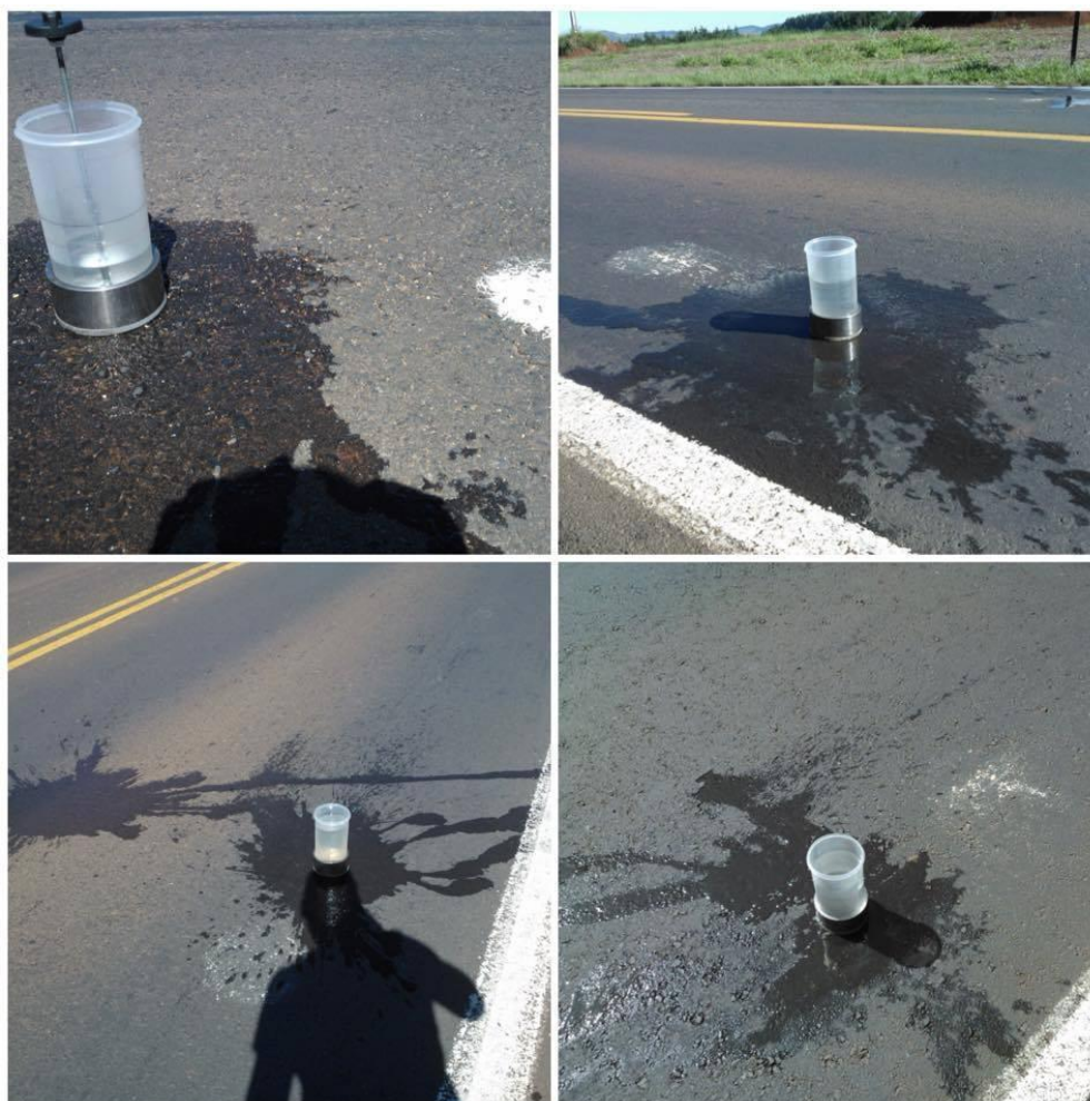
Figura 34 - Realização do Ensaio de Drenabilidade FONTE: Autoria Própria (2015)
