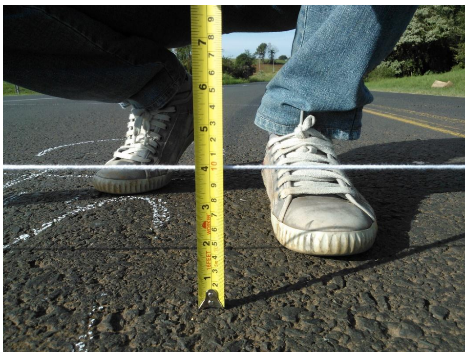
Figura 29 –Medição de flecha da trilha da roda FONTE: Autorial Própria (2015).
