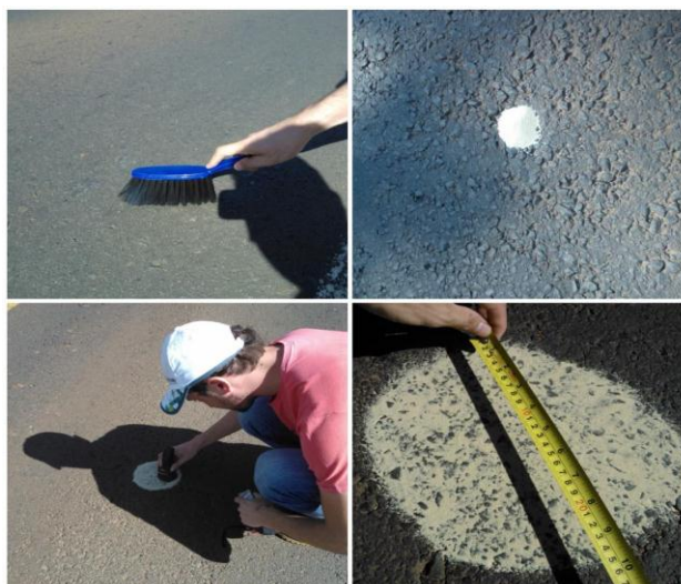
Figura 20 - Etapas envolvidas no ensaio de Mancha de Areia FONTE: Autoria Própria (2015)
