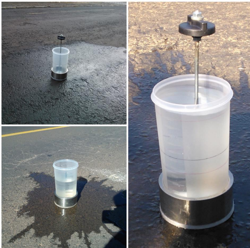
Figura 24 - Etapas envolvidas no ensaio de Drenabilidade FONTE: Aatoria Própria (2015)
