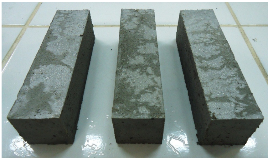
Figura 6 - Corpos de prova prismáticos de argamassa desmoldados FONTE: Autora (2015).
