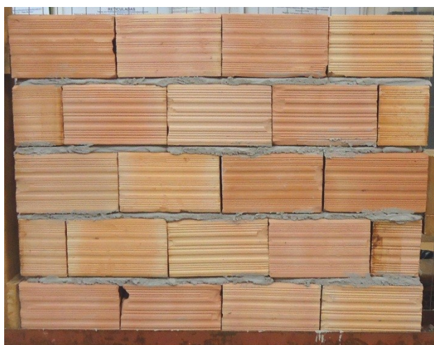
Figura 12 - Protótipo de alvenaria com juntas secas FONTE: Autora (2015).
