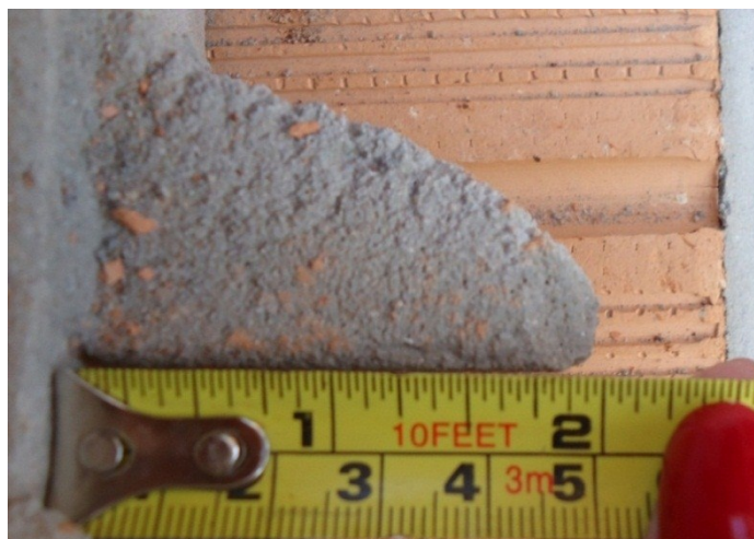
Figura 24 - Corpos de prova prismáticos de argamassa FONTE: Autora (2015).
