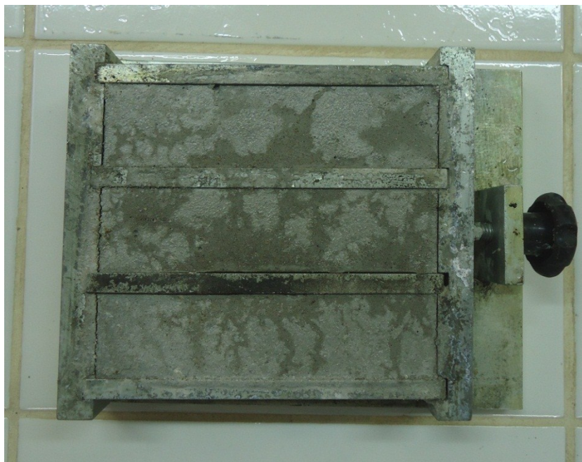
Figura 5 - Corpos de prova prismáticos de argamassa FONTE: Autora (2015).
