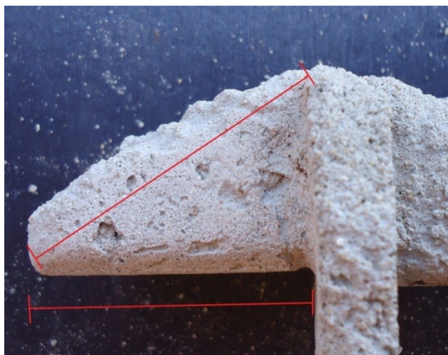
Figura 21 - Argamassa armazenada nos furos de blocos cerâmicos FONTE: Autora (2015).
