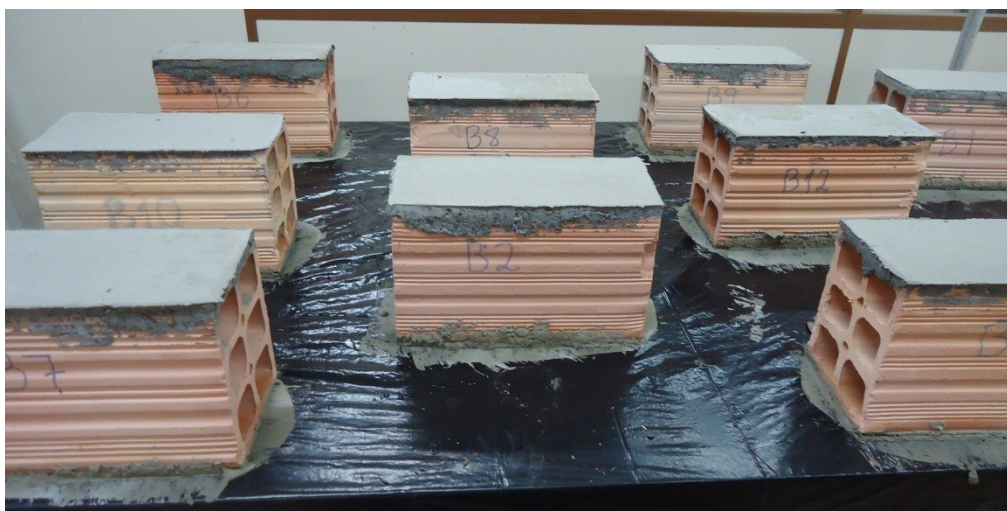
Figura 8 - Blocos cerâmicos capeados FONTE: Autora (2015).
