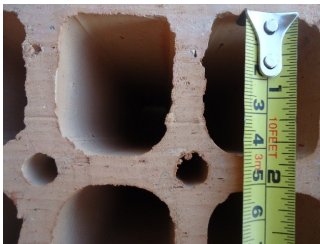
Figura 20 - Medidas dos furos dos blocos cerâmicos FONTE: Autora (2015).
