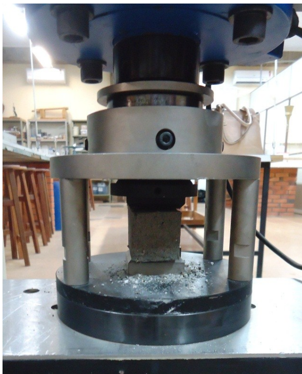
Figura 7 - Ensaio à compressão do corpo de prova de argamassa FONTE: Autora (2015).
