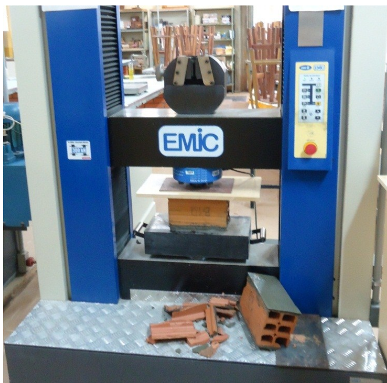
Figura 9 - Ensaio de resistência à compressão nos blocos cerâmicos FONTE: Autora (2015).
