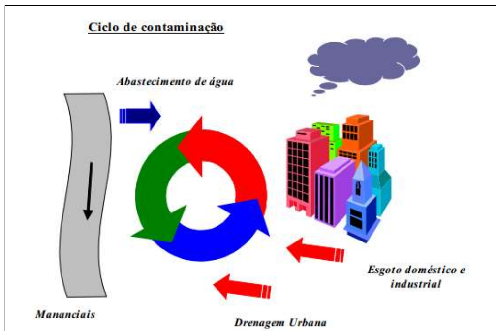
Figura 9: Ciclo da água no ambiente urbano ou ciclo de contaminação da água urbana devido a falta de tratamento de esgoto e controle do esgoto pluvial na realidade brasileira. FONTE: TUCCI, 2002.
