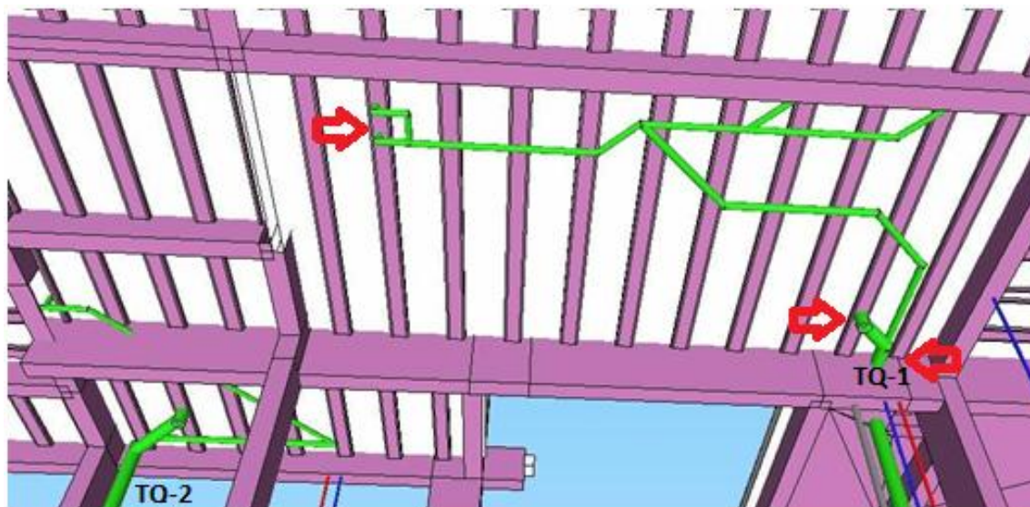
Figura 20 – Interferências entre projeto estrutural e projeto hidrossanitário: componente superior
