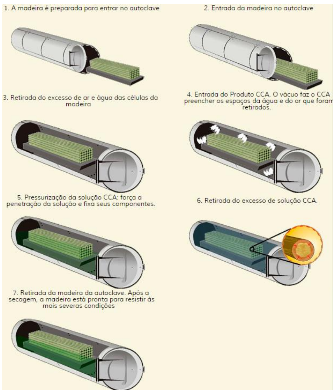
Figura 04: Processo de tratamento em autoclave Fonte: Armazém do Eucalipto, 2015.
