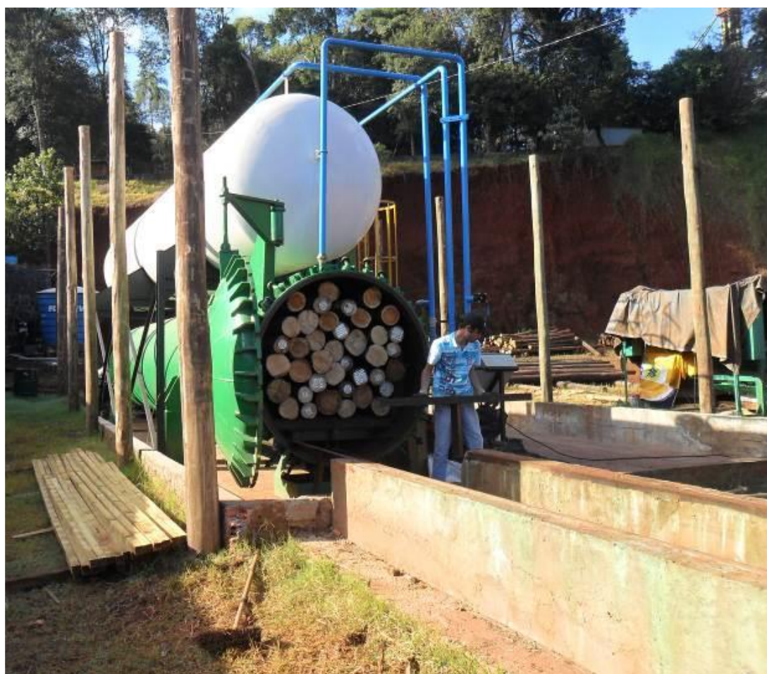
Figura 28: Auto Clave – Tratamento de Eucalipto Fonte: COSTA e BESSA, 2013.
