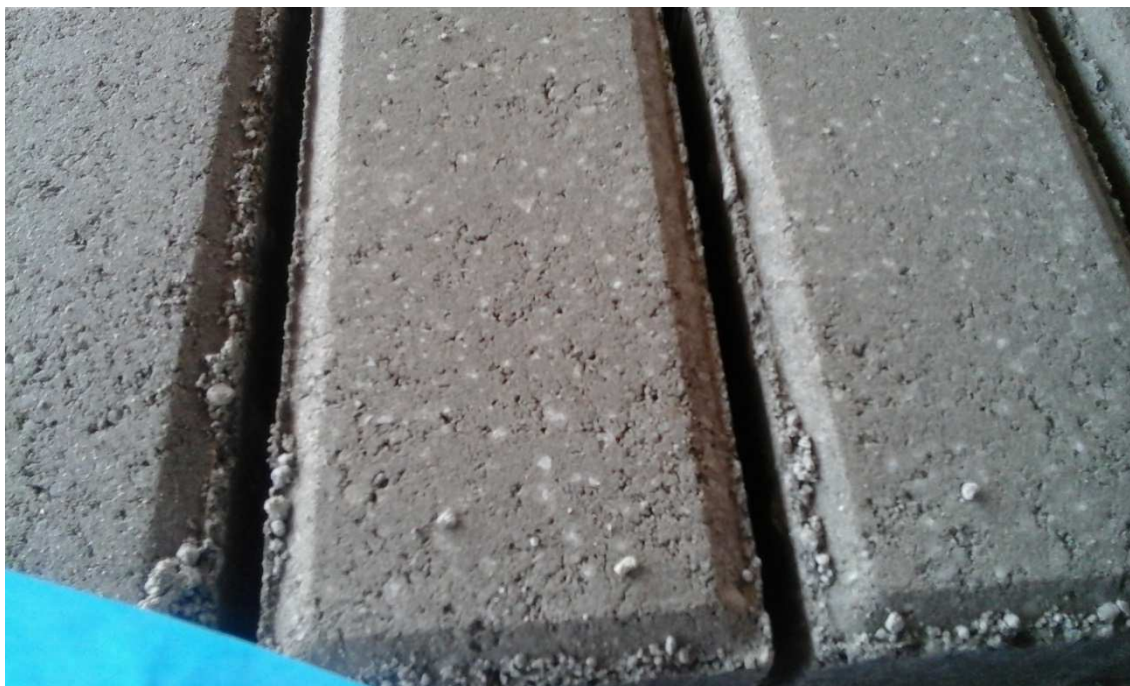
Figura 29 Traço 3 recém moldado Fonte: Autoria própria (2015)
