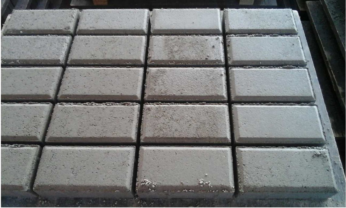
Figura 31 Traço 4 recém moldado Fonte: Autoria própria (2015)
