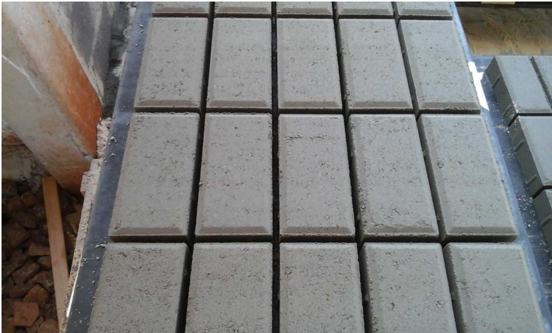
Figura 27 Traço 2 recém moldado Fonte: Autoria própria (2015)
