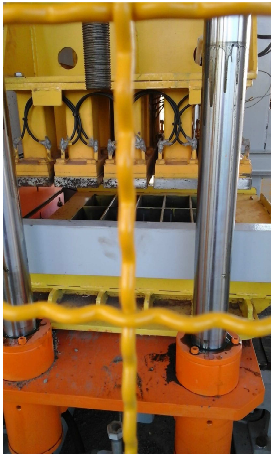
Figura 12 Molde e contramolde instalados para fabricação de pavers Fonte: Autoria própria (2015)
