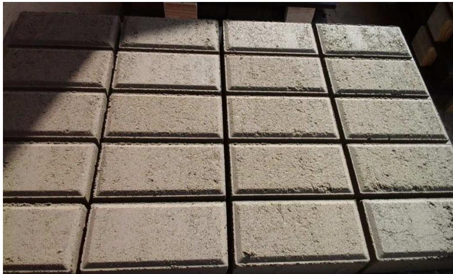
Figura 25 Traço 1 recém moldado Fonte: Autoria própria (2015)
