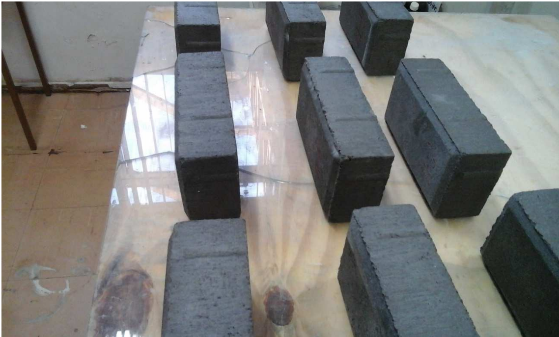
Figura 39 Amostras do traço racional saturadas Fonte: Autoria própria (2015)
