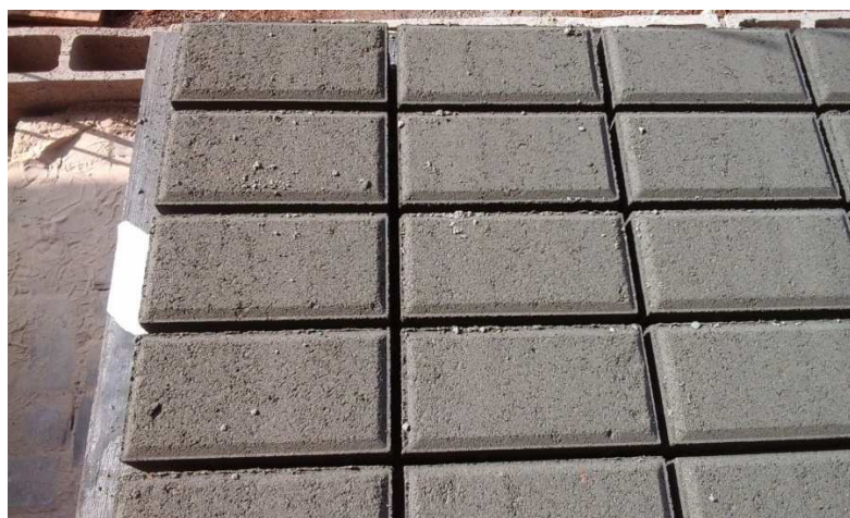
Figura 33 Traço 5 recém moldado Fonte: Autoria própria (2015)
