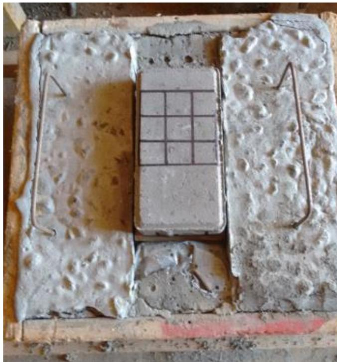
Figura 19 – Posicionamento da peça para a execução do ensaio esclerométrico na segunda empresa.
