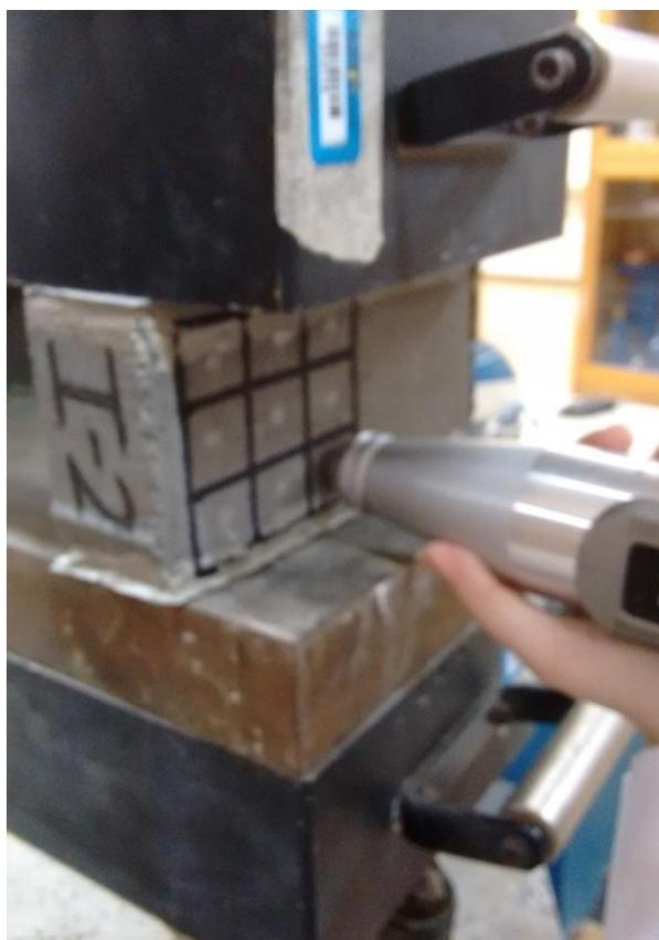
Figura 10 - Exemplo de aplicação do esclerômetro.
