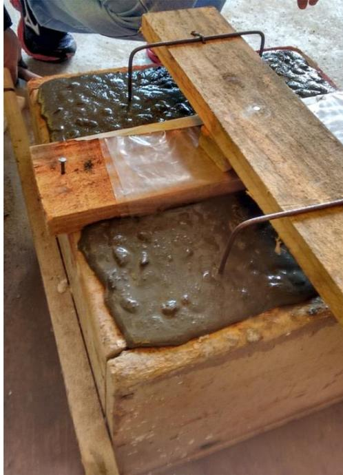
Figura 17 - Caixa para auxiliar na execução do ensaio esclerométrico (alça e plástico).
