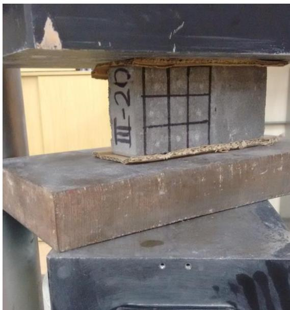
Figura 16 - Exemplo de gabarito utilizado para aplicação do esclerômetro.
