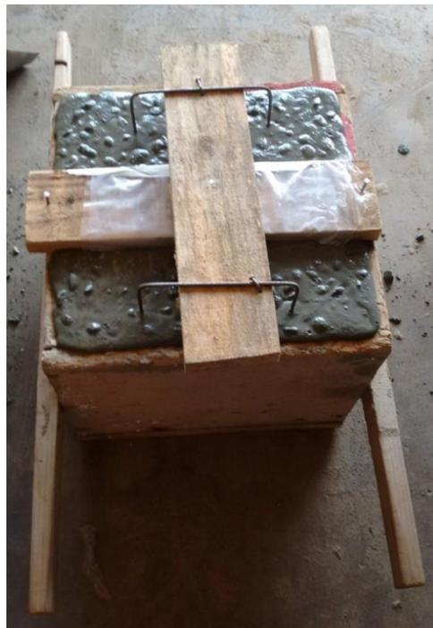
Figura 18 - Caixa para auxiliar na execução do ensaio esclerométrico.
