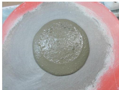
Figura 32 b - Espalhamento da argamassa com 0,25% de aditivo com 50% AB e 50% AN
