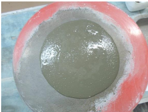
Figura 25 c - Espalhamento da argamassa com 0,30% de aditivo com 70% AB e 30% AN
