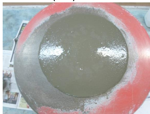
Figura 30 d - Espalhamento da argamassa com 0,35% de aditivo com 60% AB e 40% AN
