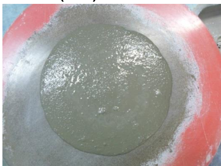
Figura 17 c – Espalhamento da argamassa com 0,30% de aditivo com 90% AB e 10% AN
