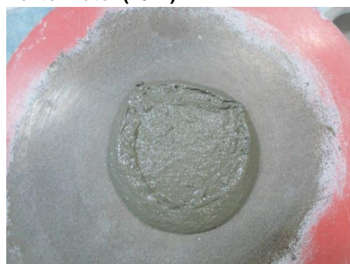
Figura 24 b - Espalhamento da argamassa com 0,25% de aditivo com 70% AB e 30% AN
