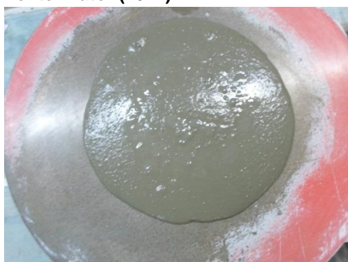
Figura 33 c - Espalhamento da argamassa com 0,30% de aditivo com 50% AB e 50% AN
