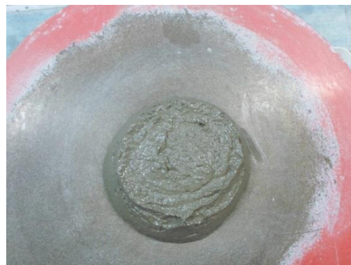
Figura 20 b - Espalhamento da argamassa com 0,25% de aditivo com 80% AB e 20% AN
