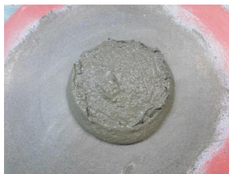
Figura 16 b – Espalhamento da argamassa com 0,25% de aditivo com 90% AB e 10% AN
