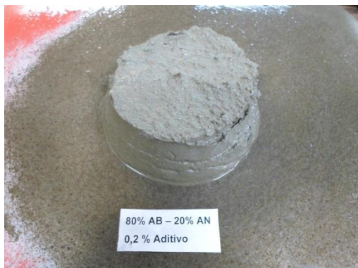
Figura 19 a - Espalhamento da argamassa com 0,2% de aditivo com 80% AB e 20% AN
