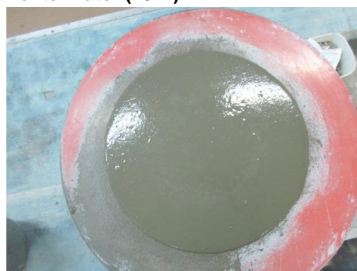
Figura 34 d - Espalhamento da argamassa com 0,35% de aditivo com 50% AB e 50% AN
