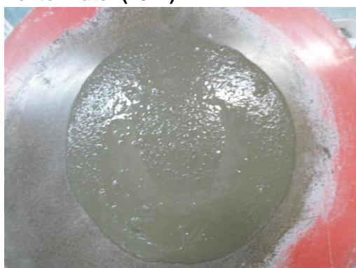
Figura 21 c - Espalhamento da argamassa com 0,30% de aditivo com 80% AB e 20% AN
