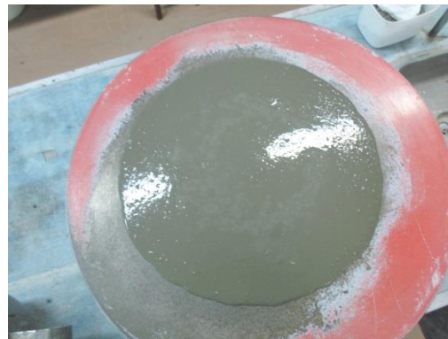
Figura 26 d - Espalhamento da argamassa com 0,35% de aditivo com 70% AB e 30% AN
