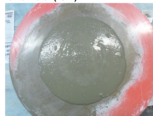
Figura 22 d - Espalhamento da argamassa com 0,35% de aditivo com 80% AB e 20% AN
