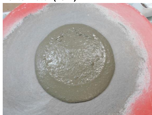
Figura 28 b - Espalhamento da argamassa com 0,25% de aditivo com 60% AB e 40% AN
