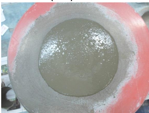
Figura 29 c - Espalhamento da argamassa com 0,30% de aditivo com 60% AB e 40% AN
