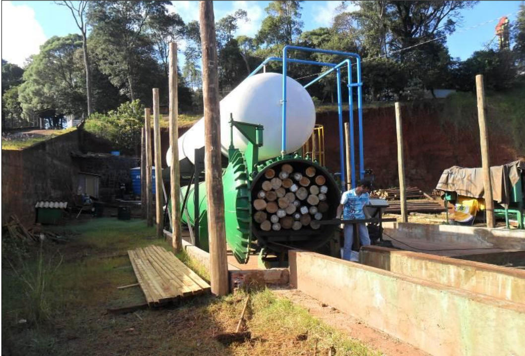
Figura 07 - Auto Clave – Tratamento Eucalipto. Fonte - Os Autores (2013).
