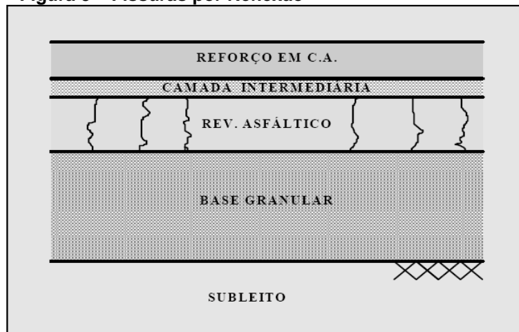
Figura 3 – Fissuras por Reflexão
