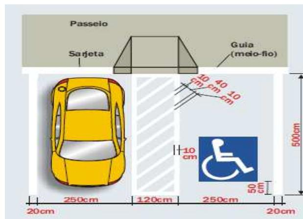
**Figura 04: Parâmetros de estacionamentos NBR 9050/2004.**
