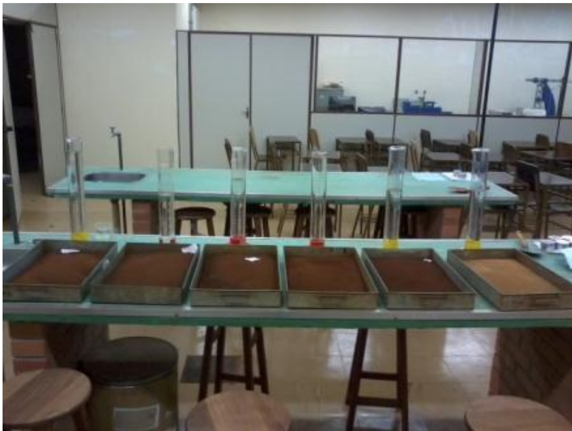
Figura 17 – Preparação das amostras de solo para o ensaio de ISC.
