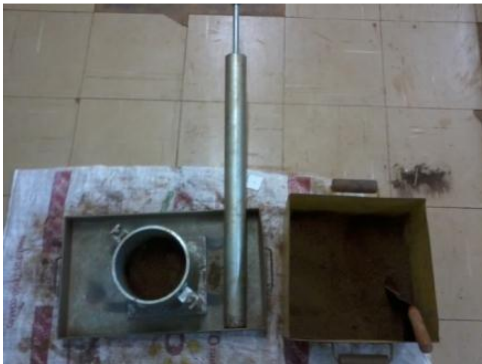
Figura 18 – Compactação do solo à umidade ótima.
