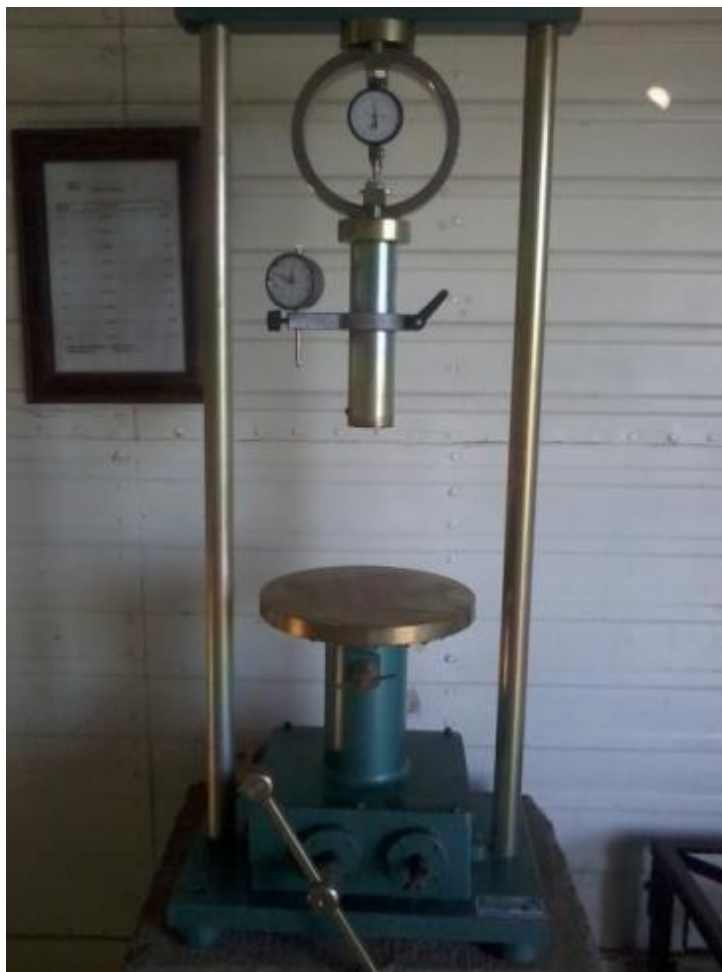
Figura 20 – Prensa para o ensaio de ISC.
