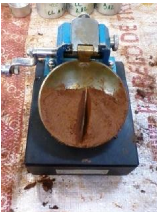
Figura 12 – Ensaio de limite de liquidez.
