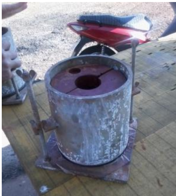
Figura 22 – Corpo-de-prova preparado para o ensaio de penetração.
