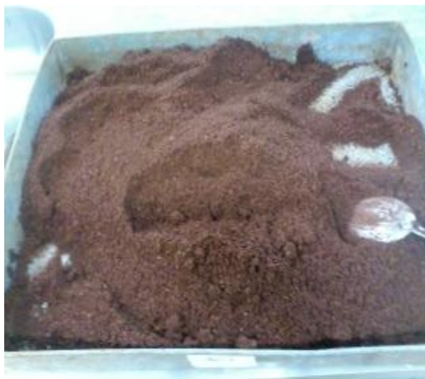
Figura 13 – Amostra preparada para o ensaio de compactação.
