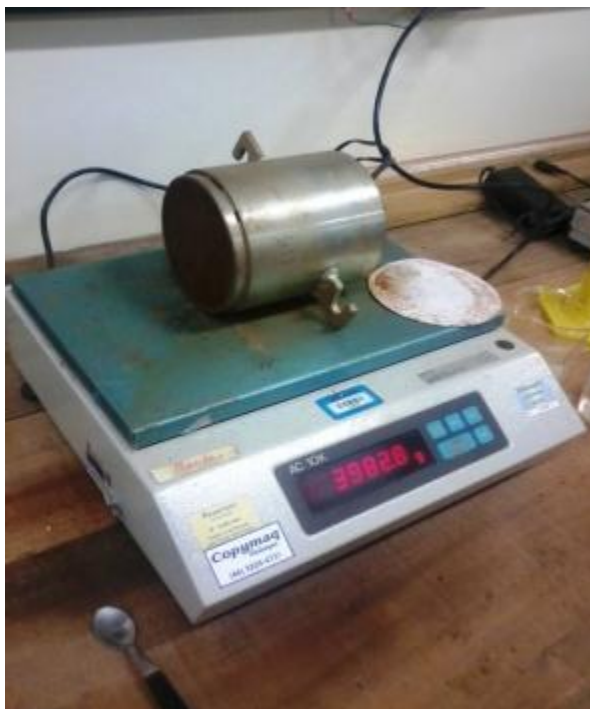
Figura 15 – Pesagem conjunto molde e solo.
