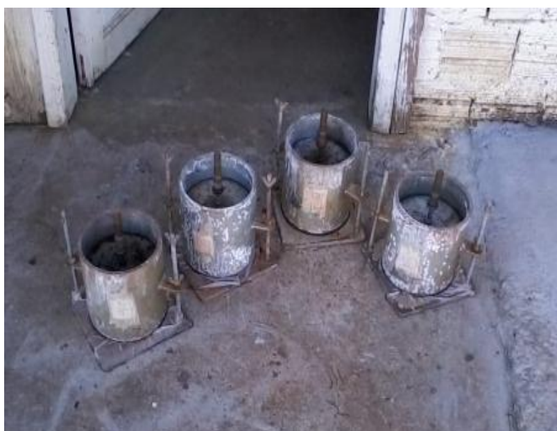
Figura 21 – Corpos-de-prova sendo escoados para o ensaio de penetração.
