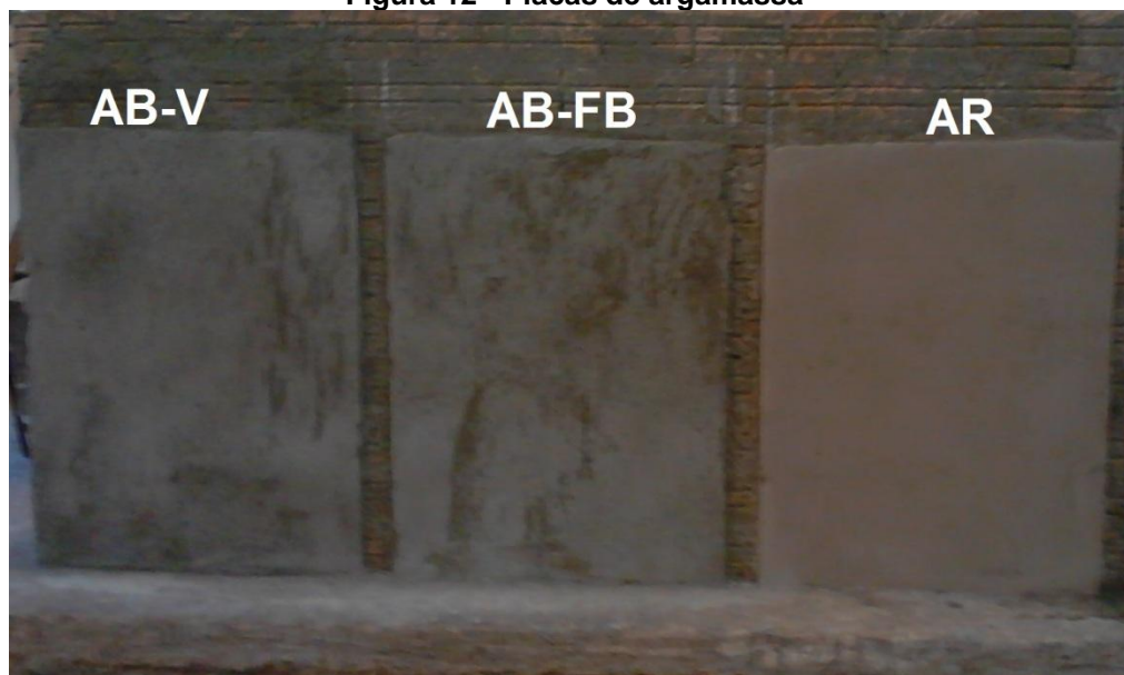
Figura 12 - Placas de argamassa
