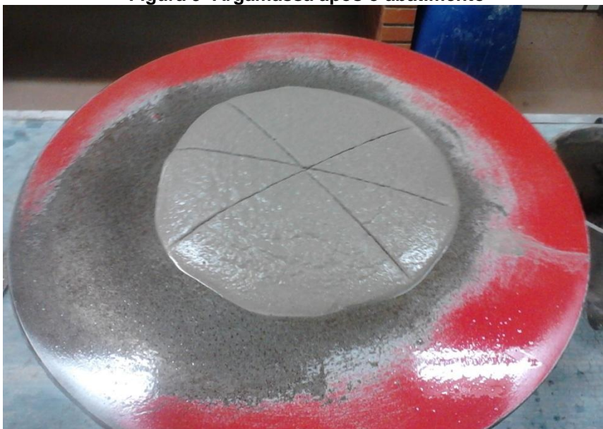
Figura 9–Argamassa após o abatimento
