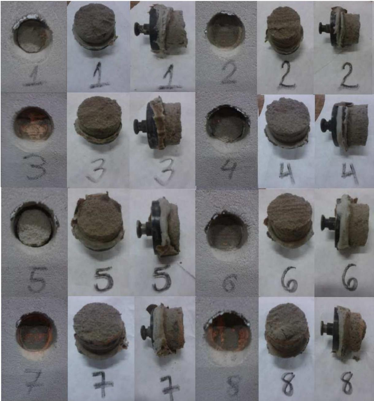
Figura 34: Ensaio de tração – argamassa de referência com polímero e sem execução do chapisco.
