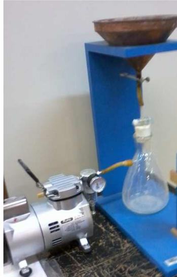
**Figura 9: Equipamento para determinação do Índice de Retenção de água.**
