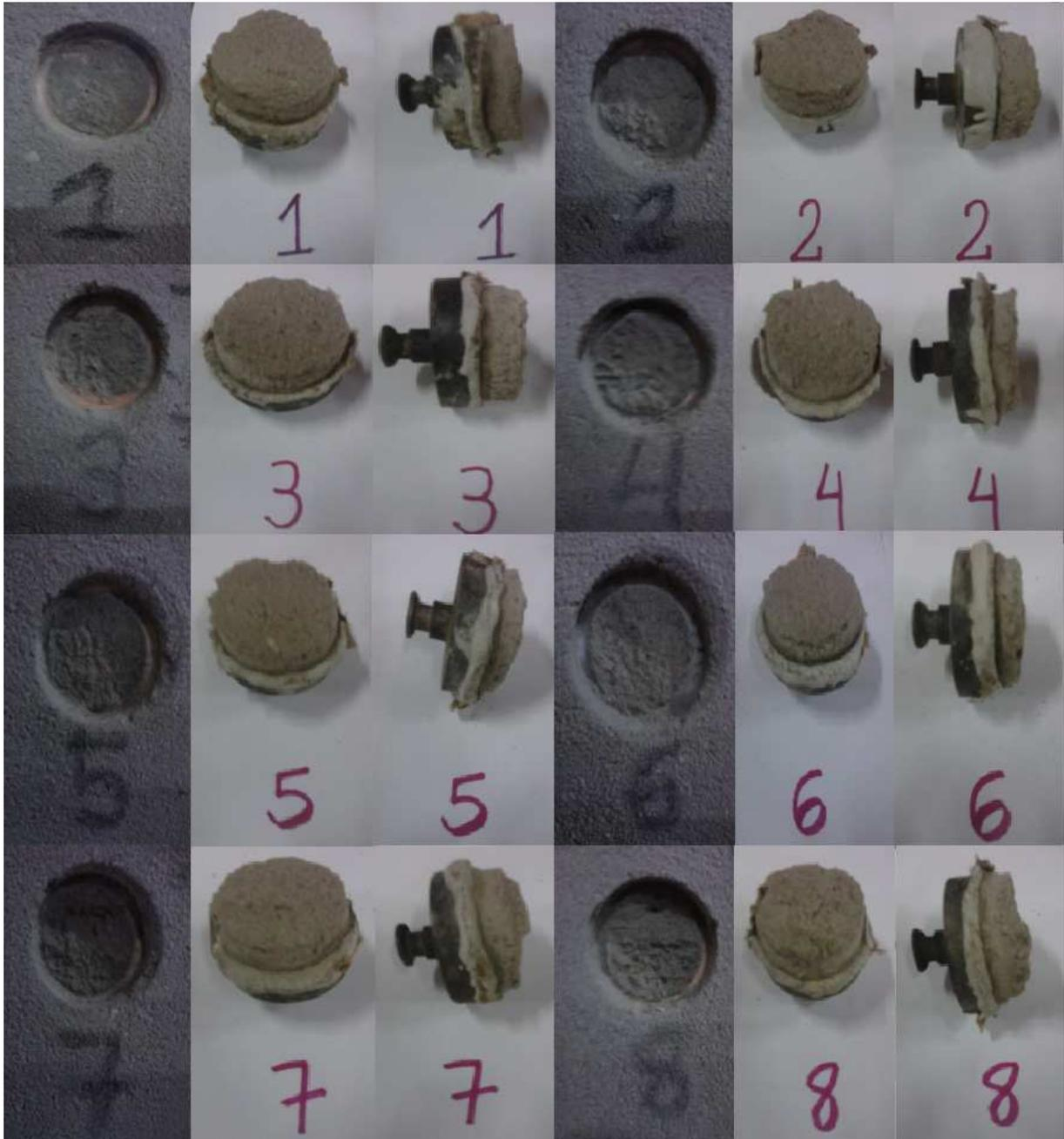
Figura 35: Ensaio de tração – argamassa de referência sem polímero e com execução do chapisco.
