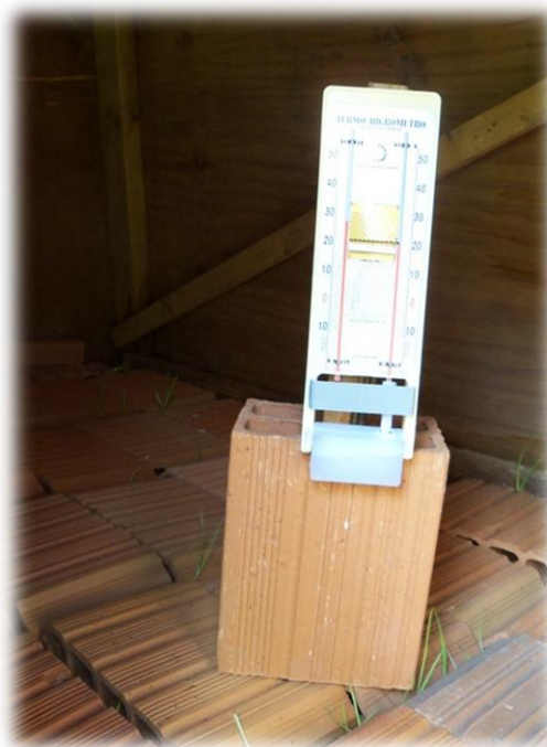
Figura 15 – Termohigrômetro no interior do protótipo da cobertura verde. Fonte: Autora (2013).
