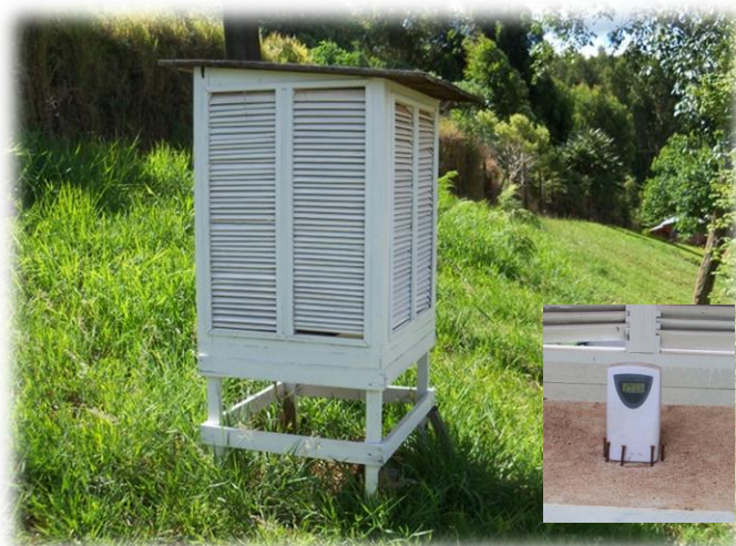
Figura 16 – Abrigo metereológico, com detalhe do Termohigrômetro analógico interno. Fonte: Autora (2013).
