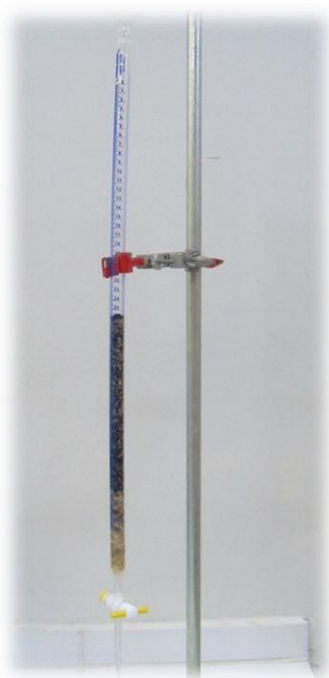
Figura 26 – Filtro rápido, montado com cascalho, areia e carvão antracito. Fonte: Autora (2013).
