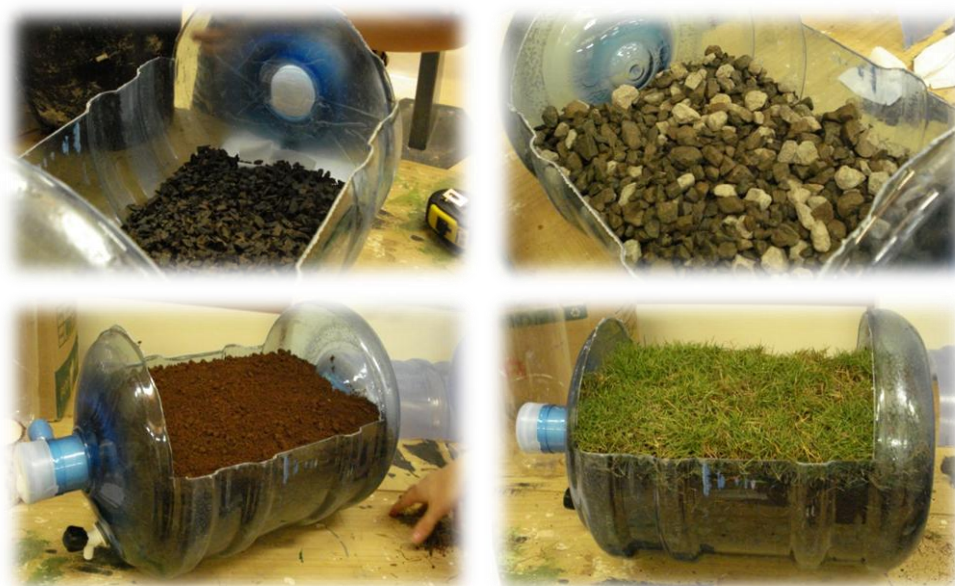
Figura 05 – Processo de montagem das camadas dos protótipos feito em laboratório. Fonte: Autora (2012).
