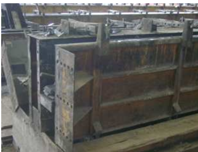
Fotografia 1 – Forma estacionária metálica com regulagem de seção Fonte: Autoria própria
