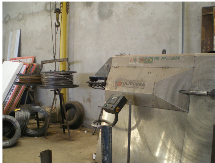
Fotografia 2 – Sistema automatizado de corte e dobra de barras transversais Fonte: Autoria própria
