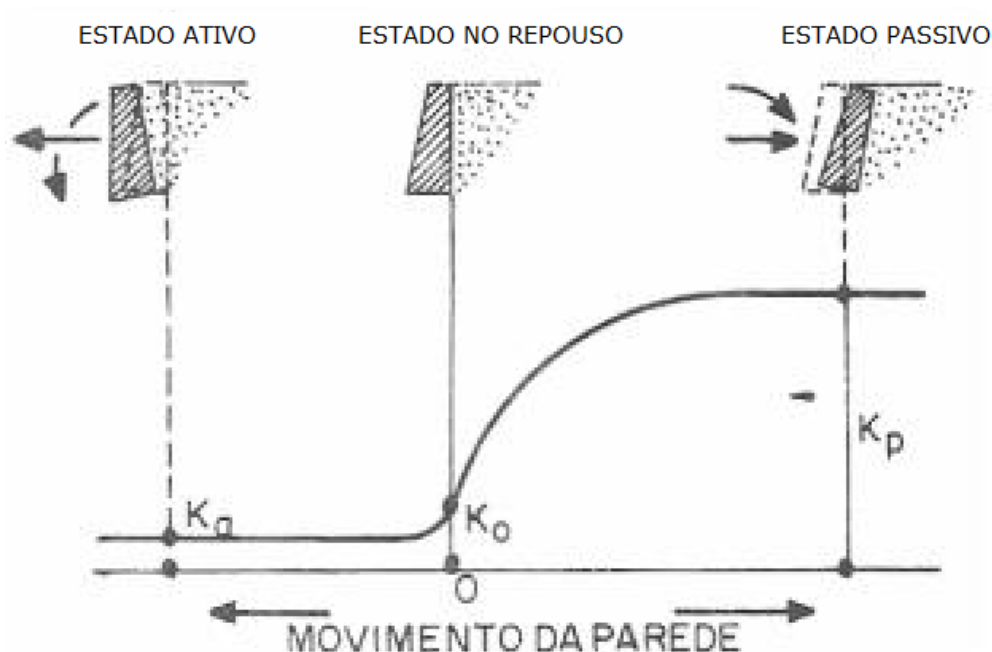
Figura 1: Empuxos ativo, no repouso e passivo Fonte: CAPUTO (1987)
