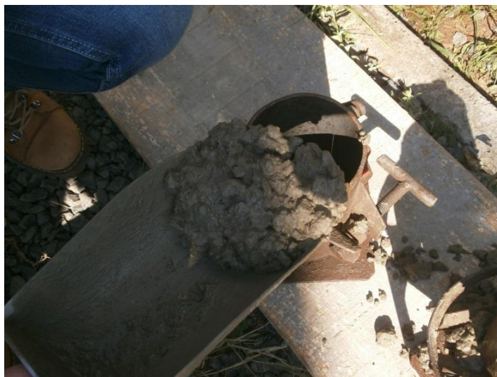
Figura 2: Colocação do concreto no molde Fonte: Autoria própria
