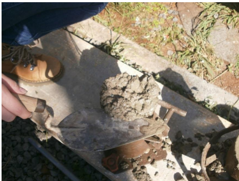
Figura 4: Arrasamento do concreto no molde Fonte: Aatoria própria
