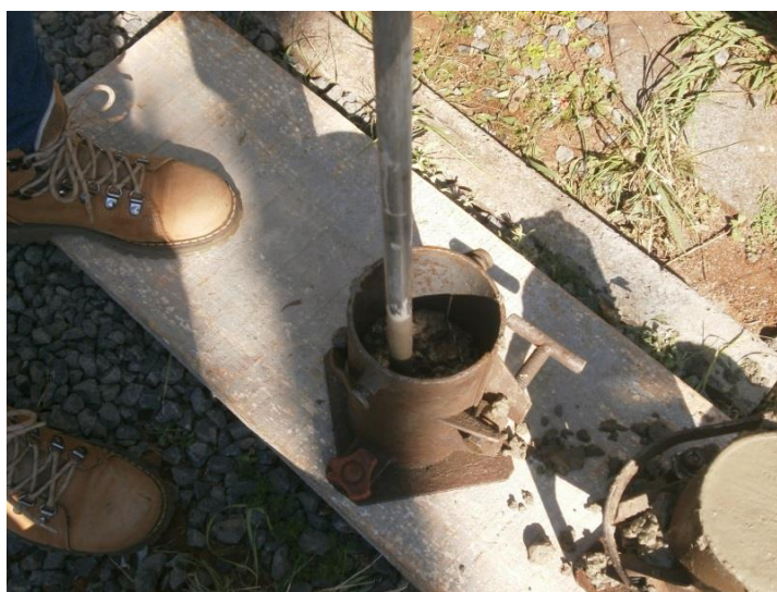
Figura 3: Adensamento do concreto no molde Fonte: Autoria própria
