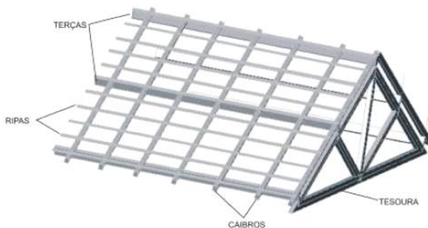
Figura 10 – Elementos que compõem a estrutura da cobertura Fonte: Meirelles e Pala (2010, p. 34).
