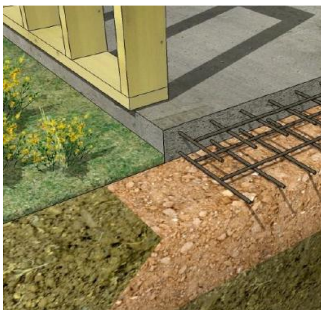
Figura 4 – Fundação do tipo radier Fonte: Tecverde
