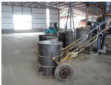
Figura 37 - Transporte do Tubo de Concreto Após Moldagem Fonte: Autoria Própria
