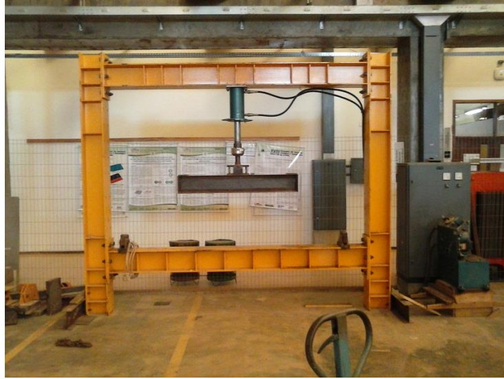
Figura 13 - Pórtico com Conjunto Hidráulico Fonte: Autoria Própria
