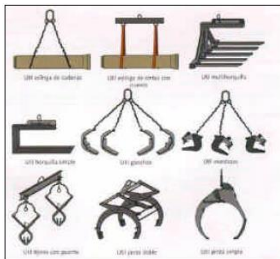
Figura 8 – Equipamentos para Movimentação de Tubos Fonte: Barreto (2003)
