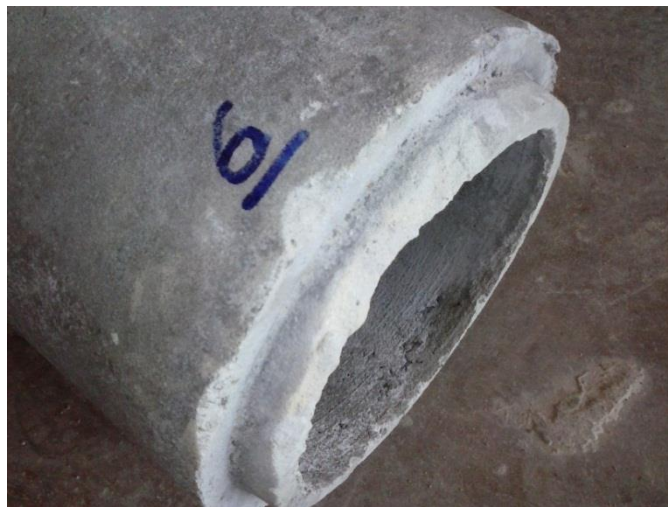
Figura 24 – Defeito de Acabamento na Borda Superior do Macho do Tubo Número 6 Fonte: Autoria Própria
