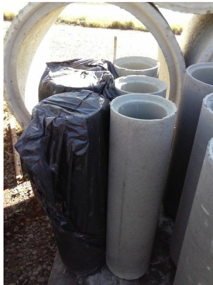
Figura 31 – Tubos de Concreto Encamisados Fonte: Autorial Própria
