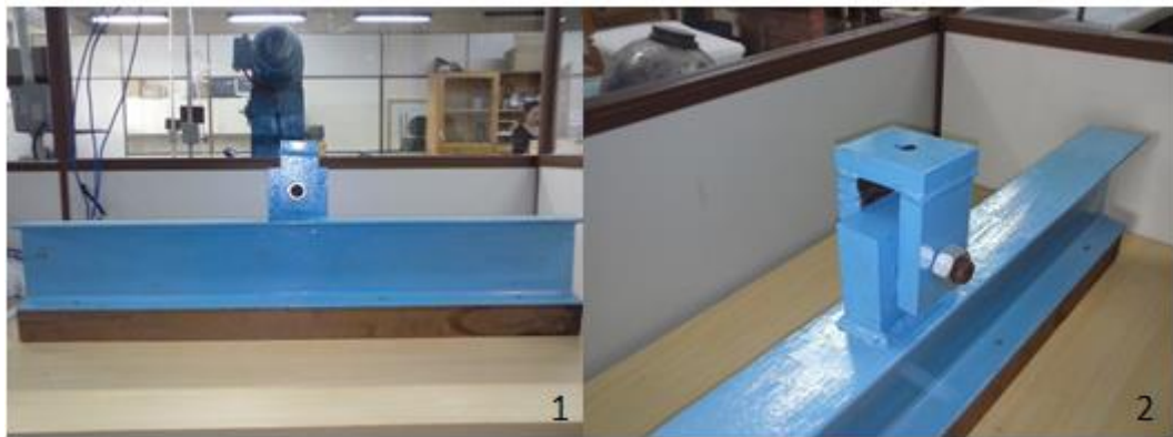
Figura 11 – Viga Superior (1); Dispositivo de Articulação e Acoplamento (2) Fonte: Autoria Própria
