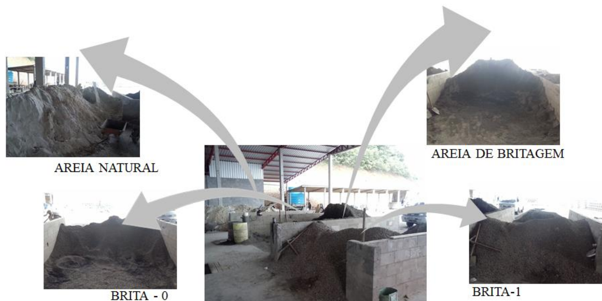
Figura 34 – Baias de Armazenamento dos Agregados
