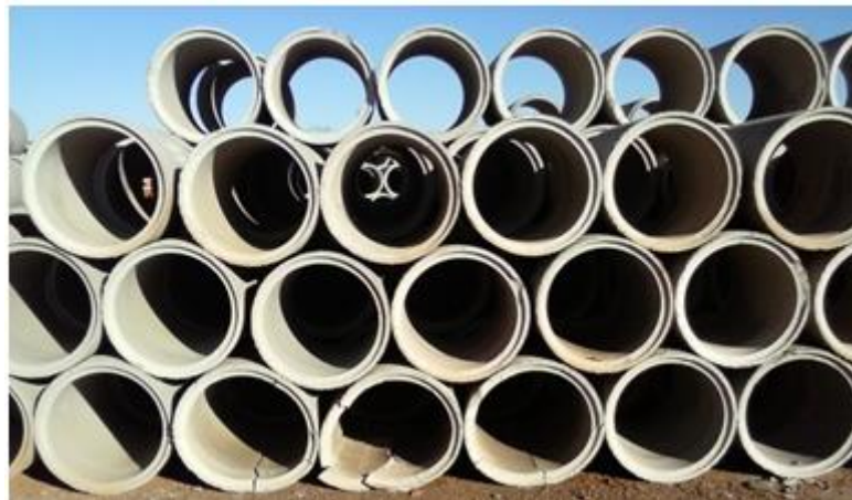
Figura 38 – Tubos de Concreto Rompidos Fonte: Autoria Própria
