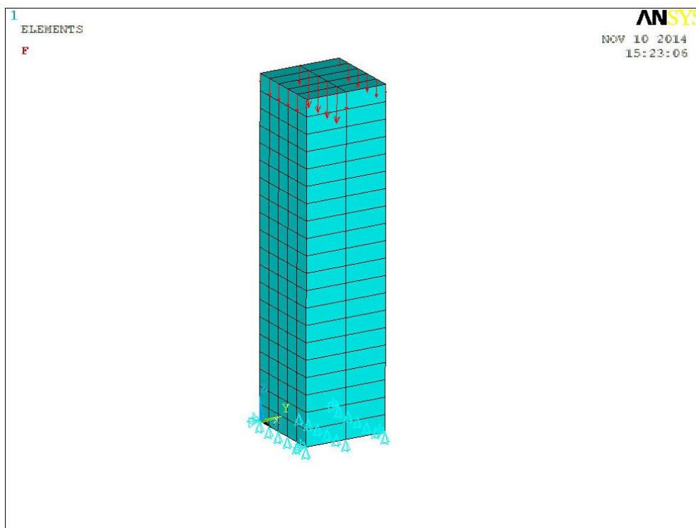
Figura 12- Malha distorcida, com carregamento e restrição de apoio.
