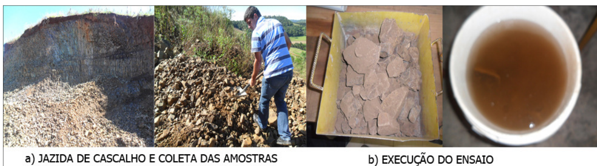
Figura 23 - Sequência ensaio de determinação da massa específica do agregado grúdo FONTE: Autoria Própria (2014).
