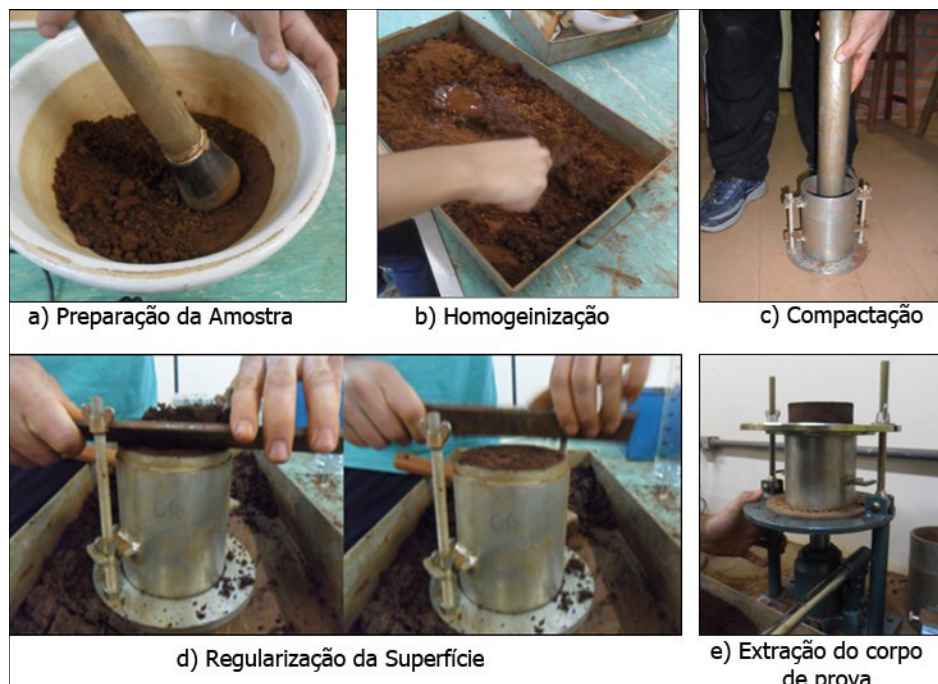
Figura 18 - Sequência ensaio de compactação FONTE: Autoria Própria (2014).
