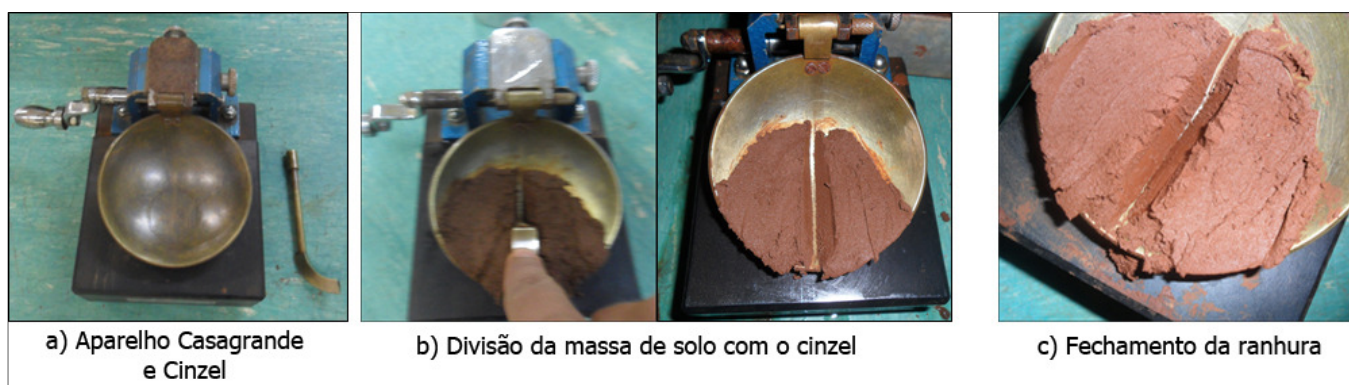
Figura 20 - Sequência para determinação do Limite de Liquidez FONTE: Autorial Própria (2014).
