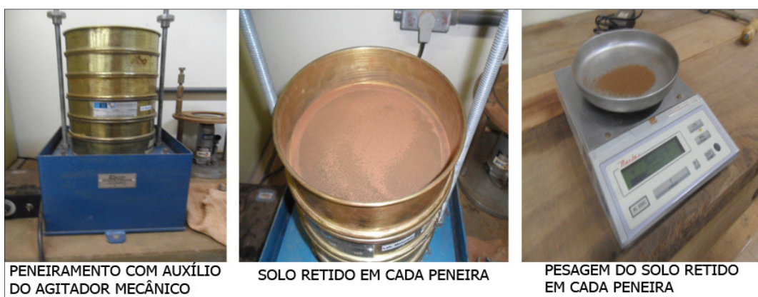
Figura 19 – Sequência do ensaio de granulometria
