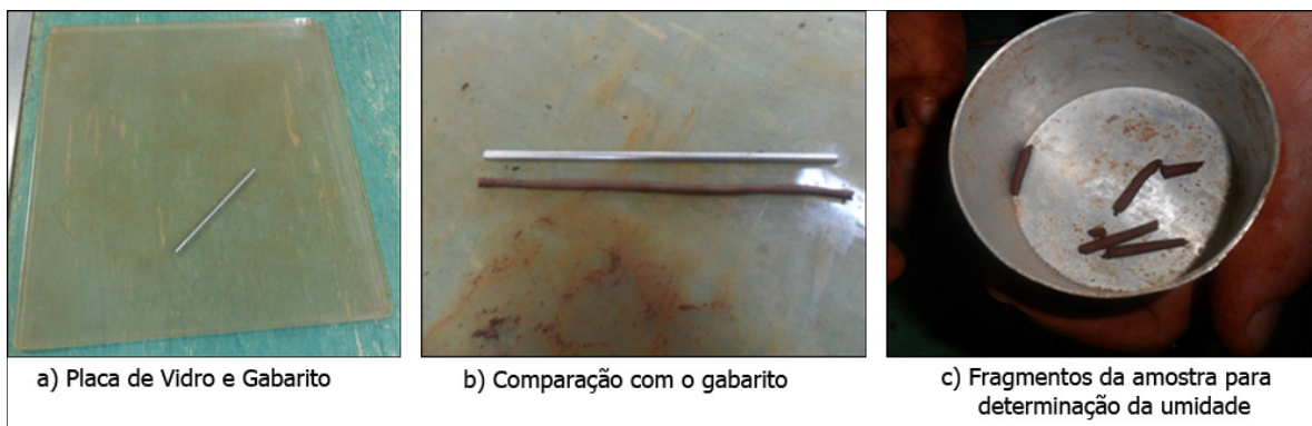
Figura 21 - Sequência determinação Limite de Plasticidade
