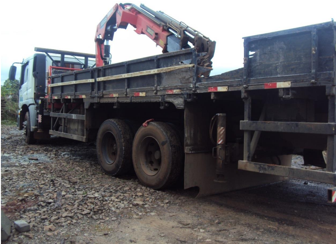
Figura 10 - Carroceria de caminhão danificada após a queda de uma peça fixada indevidamente. Fonte: Autoria própria (2014)
