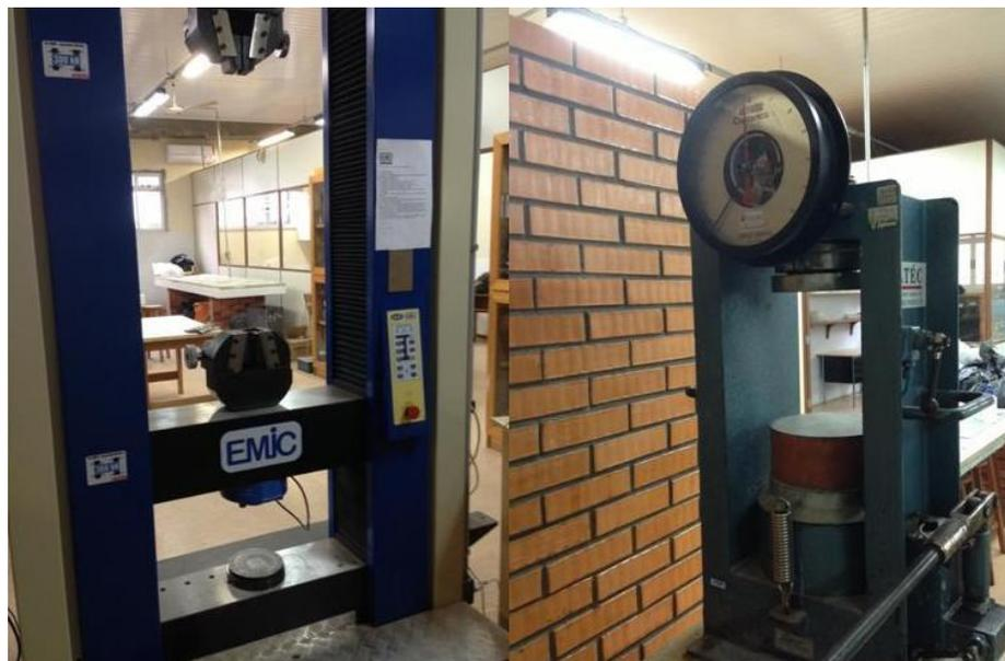
**Figura 19 – Prensa para ensaio de resistência à compressão**
