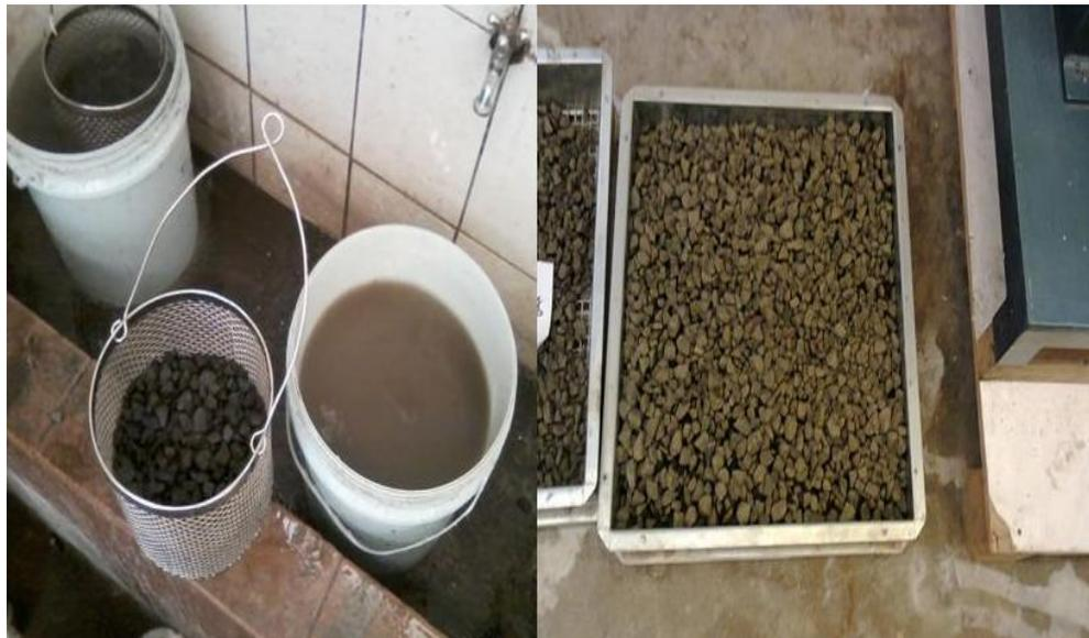
**Figura 15 -a) brita lavada; b) brita secando ao ambiente**
