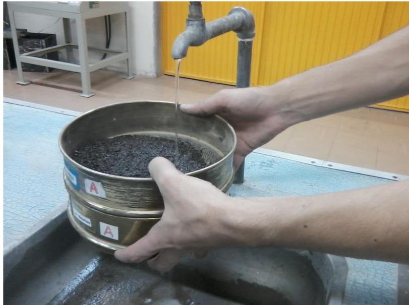
**Figura 09 - Determinação do material pulverulento do agregado miúdo**
