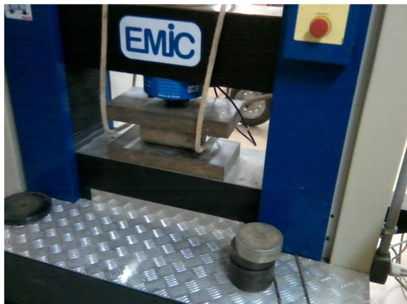
**Figura 20 – Ensaio de tração por compressão diametral**
