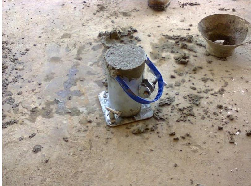
**Figura 14 - Corpo-de-prova**
