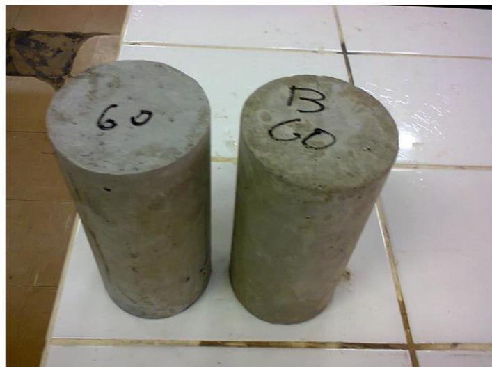
**Figura 26 - Pouca diferença de coloração entre corpos-de-prova**
