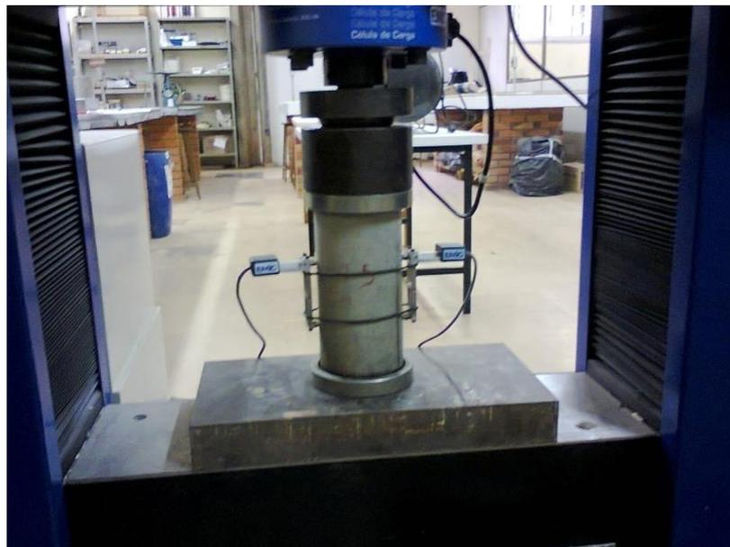
**Figura 21 – Ensaio de módulo de elasticidade**
