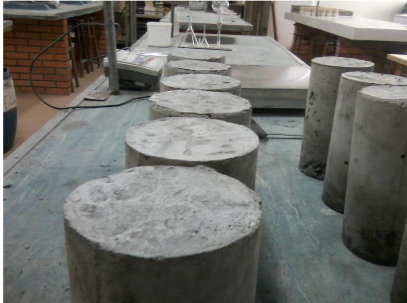
**Figura 18 - Superfície irregular dos corpos-de-prova**
