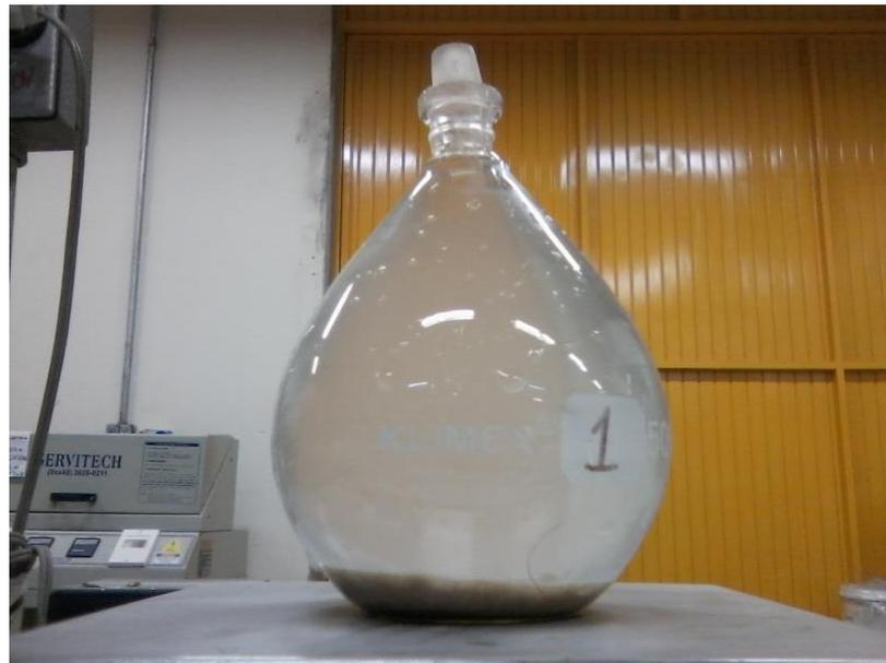
**Figura 10 - Determinação da massa específica aparente através do método do picnômetro**
