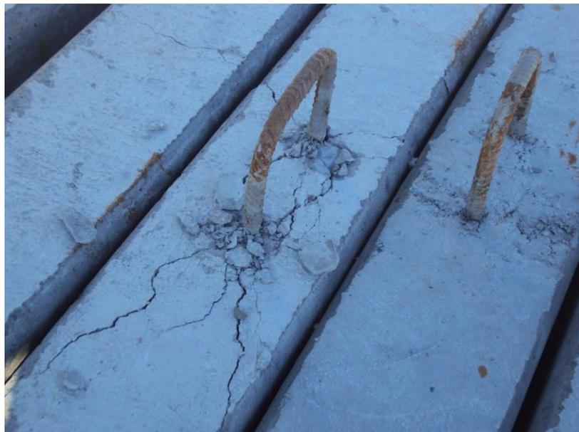
**Figura 03 – Fissuras decorrentes do içamento prematuro da peça**
