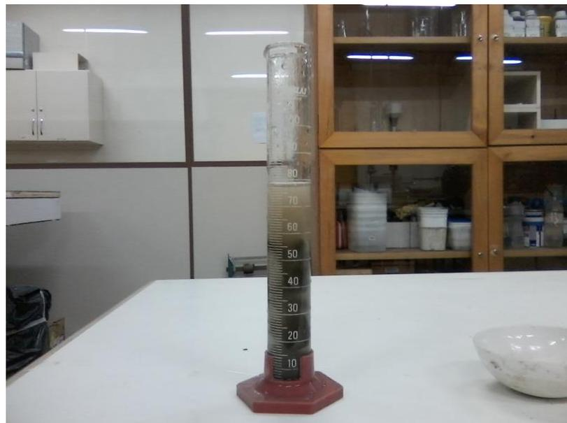
**Figura 13 - Determinação da massa específica aparente da brita**
