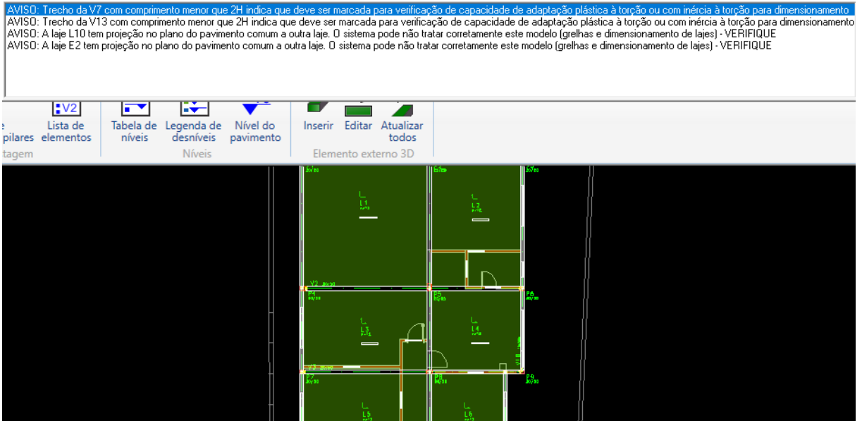
Figura 29: Janela de avisos de consistência da planta no modelador estrutural - programa TQS
