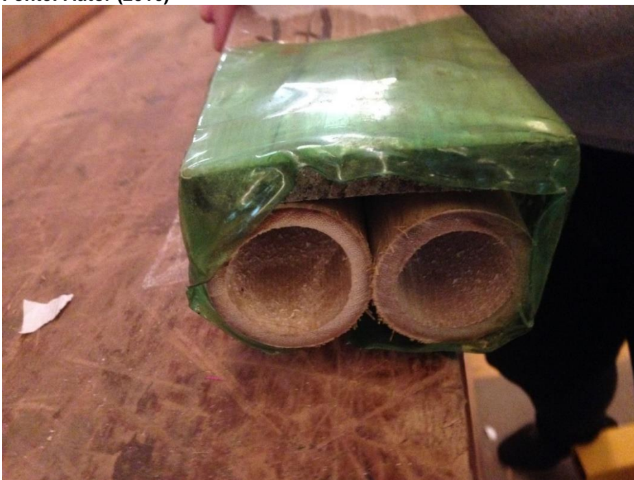
Figura 21 – Corpo de prova BF11: após aplicação de carga – Carga máxima aplicada de 13,13 kN Fonte: Autor (2016)
