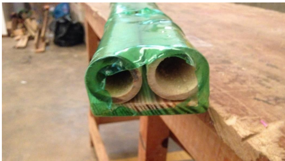
Figura 23 – Corpo de prova BF9: colmos com espessuras uniformes – Carga máxima aplicada de 11,37 kN Fonte: Autor (2016)
