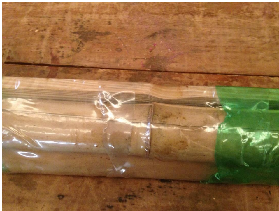
Figura 20 – Corpo de prova BF11: local de aplicação da carga – Carga máxima de 13,13 kN Fonte: Autor (2016)
