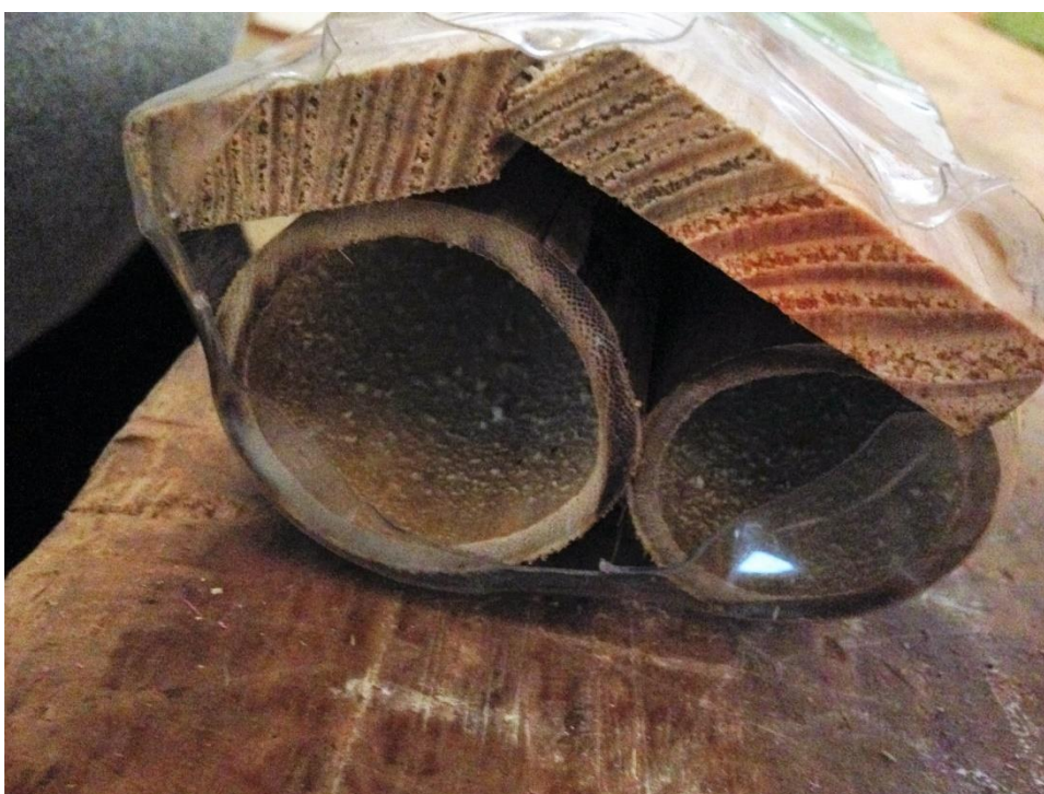
Figura 28 – Corpo de Prova BF8: rompido por torção– Carga máxima aplicada de 8,26 kN Fonte: Autor (2016)
