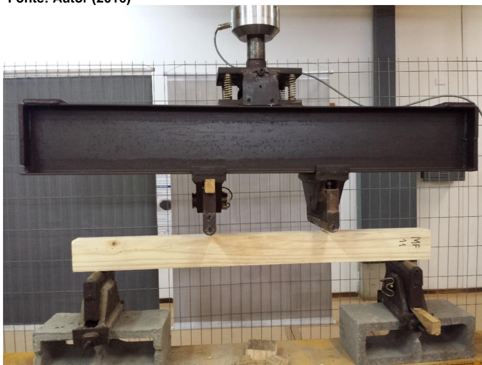
Figura 38 – Corpo de prova MF11: pequeno nó presente – Carga máxima aplicada de 21,89 kN Fonte: Autor (2016)
