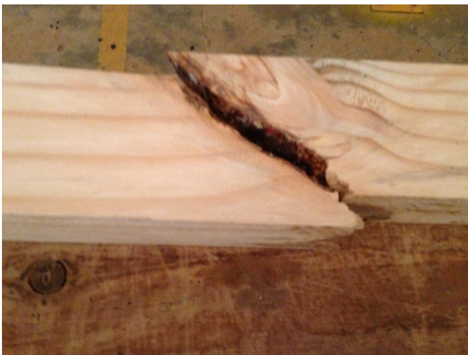
Figura 31 - Corpo de prova MF05: depois de ser ensaiado – Carga máxima aplicada de 8,43 kN
