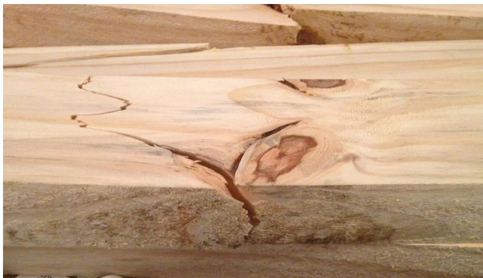
Figura 34 – Corpo de prova MF1: Rompimento próximos aos nós – Carga máxima aplicada de 11,97 kN Fonte: Autor (2016)
