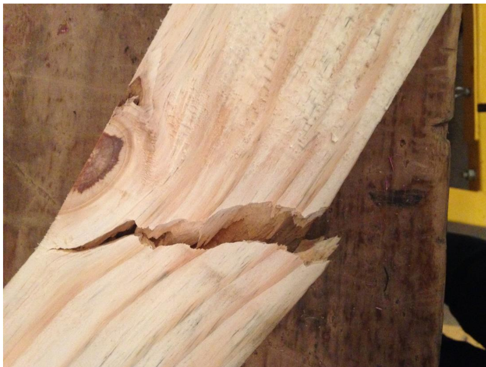
Figura 33 – Corpo de prova MF4: Rompimento próximos aos nós – Carga máxima aplicada de 11,05 kN Fonte: Autor (2016)
