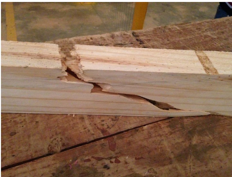
Figura 40 – Corpo de prova MF11: rompimento por flexão – Carga máxima aplicada de 21,89 kN Fonte: Autor (2016)
