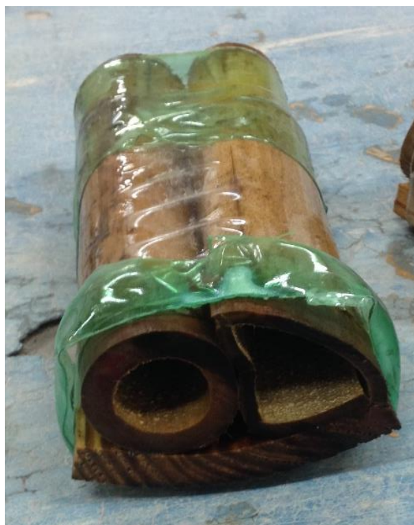
Figura 42 - Corpos de provas de madeira e bambu envolvidos com PET deformados após ensaio de densidade Fonte: Autor (2016)
