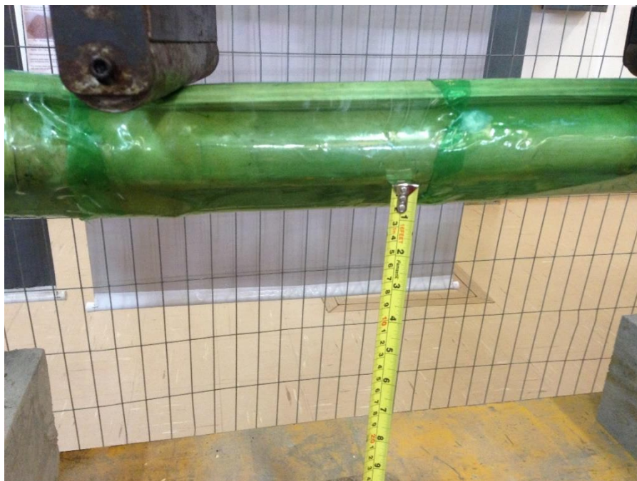
Figura 25 – Corpo de prova BF4: corpo de prova torcido – Carga máxima aplicada de 10,03 kN
