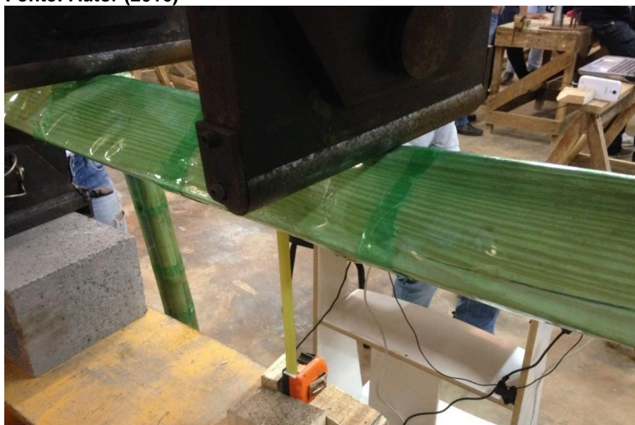
Figura 26 – Corpo de prova BF4: aplicação de carga no corpo de prova – Carga máxima aplicada de 10,03 kN
