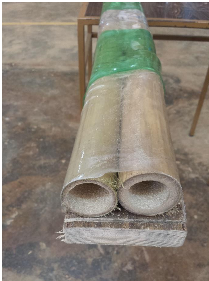
Figura 16 – Colmos de bambu dispostos inversamente Fonte: Autor (2015)
