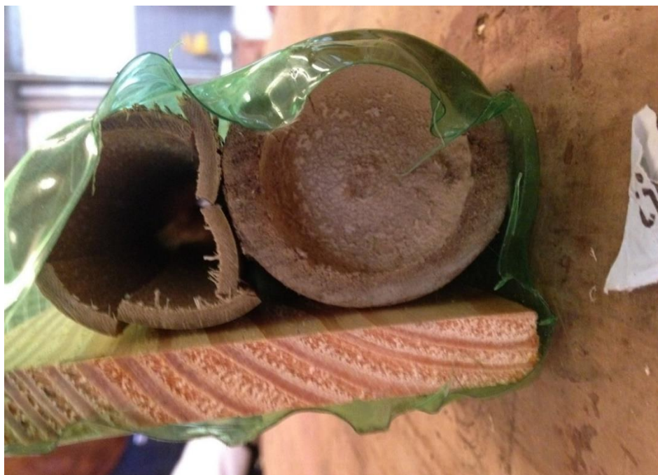
Figura 24 – Corpo de prova BF2: Nós nos colmos de bambu próximos a extremidade – Carga máxima aplicada de 12,57 kN
