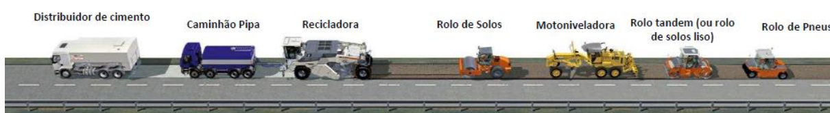
Figura 9: Sequência de execução da reciclagem de pavimentos Fonte: Adaptado de WIRTGEN (2012).
