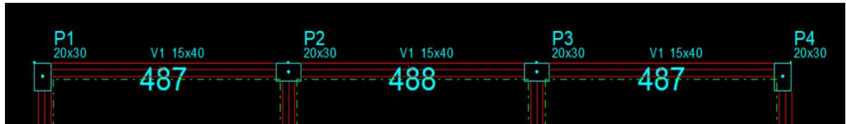
Figura 26: Viga 1 sem redução de engaste Fonte: O Autor.
