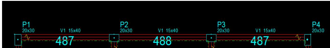
Figura 29: Viga 1 com redução de engaste em 25% Fonte: O Autor.
