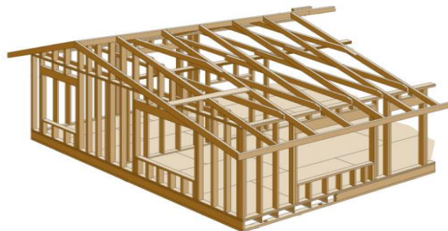
Figura 9 – Estrutura do telhado Wood frame.
