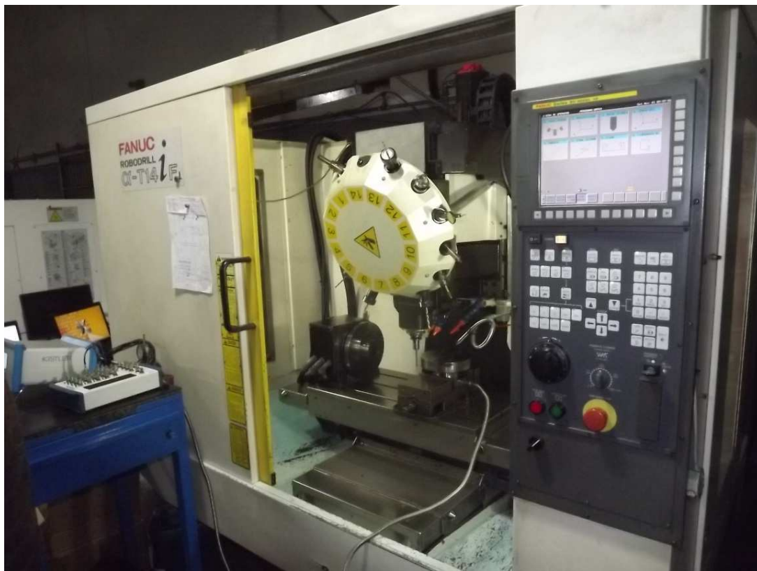
Figura 3.14 – Centro de usinagem FANUC ROBODRILL utilizado nos ensaios práticos
