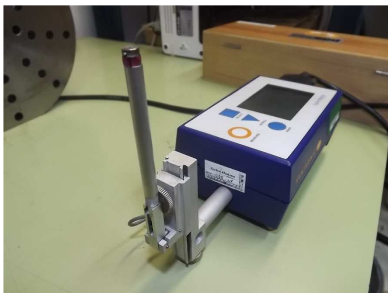
Figura 3.17 – Rugosímetro Taylor Hobson modelo Surtronic 25
