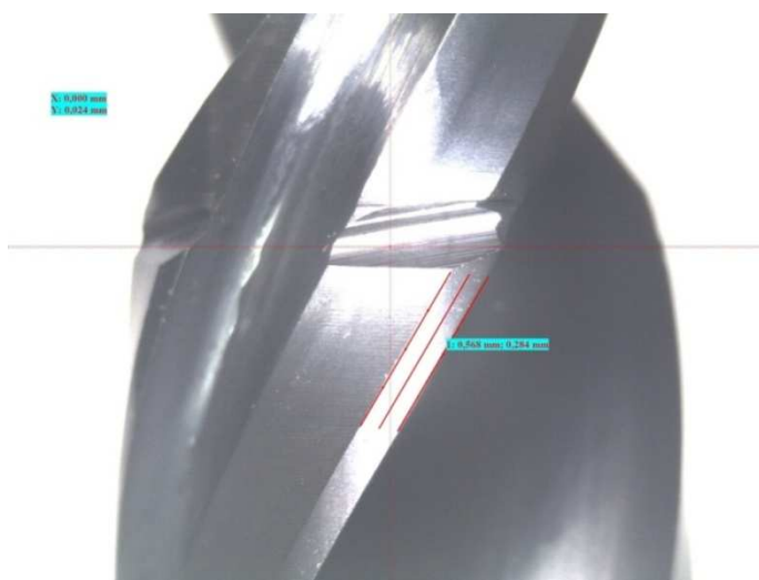
Figura 3.7 - Diâmetro escalonado da broca alargadora com quatro gumes
