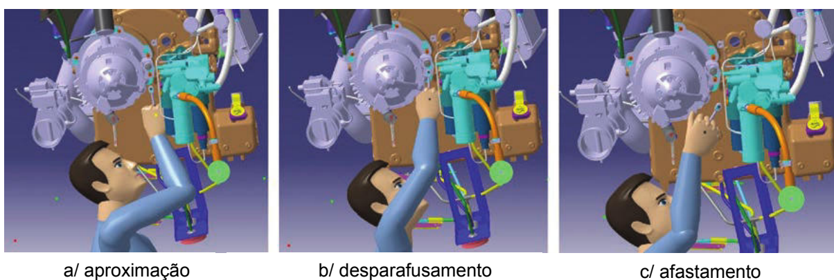
Figura 13 – Verificação da acessibilidade utilizando realidade virtual
